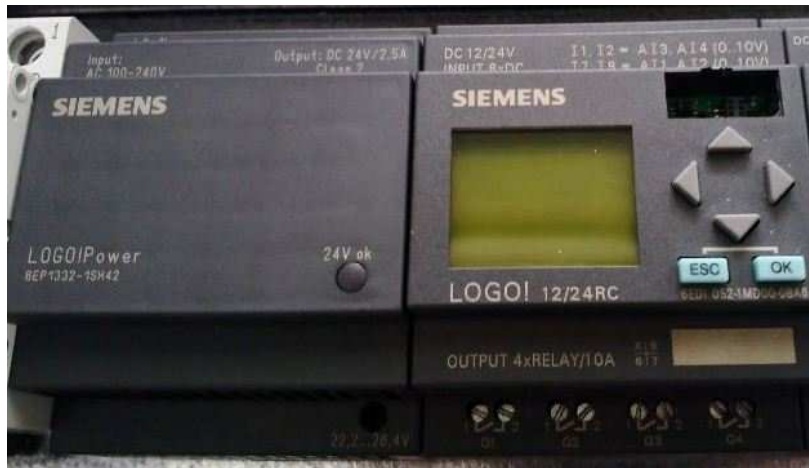
KUVA 2. Siemens LOGO! Power teholähde ja 12/24RC keskusyksikkö /4/.
