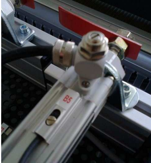
KUVA 28. Kuvassa reed-kytkin ja pneumatiikkasylineri /4/.
