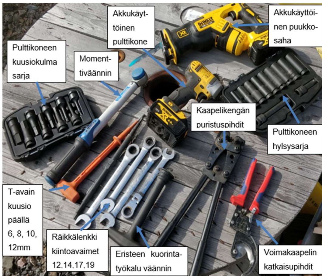
Kuva 10. Tärkeitä KJ-maakaapelijatkon tekemiseen tarvittavat työvälineet.
