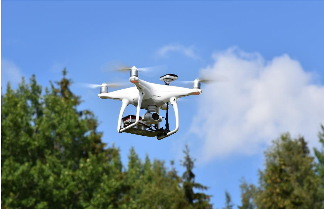
Kuva 4. Tutkimuksessa käytettiin DJI Phantom 4 Pro -droonia ja siihen liitettyä Micasense RedEdge-MX -multispektrikameraa (Markus Haapamäki 2019).
