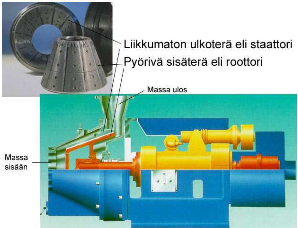
Kuva 12. Kartiojauhimen rakenne /9/
