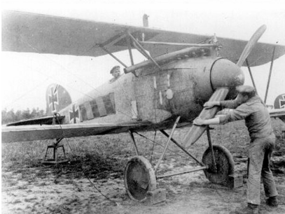
KUVIO 5. Albatros D.III -hävittäjä, jossa on Mercedes D.III –rivimoottori (Early Aviation. 2008)
