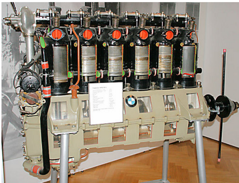
KUVIO 8. BMW IIIa -moottori (Flugmotor BMW IIIa: Wassergekühlter 6-Zylinder-Reihenmotor von 1917. n.d.)
