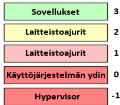
Kuva 3. AMD V- ja Intel VT -laajennuksen omaavien x86-prosessorien suojaustasot.
