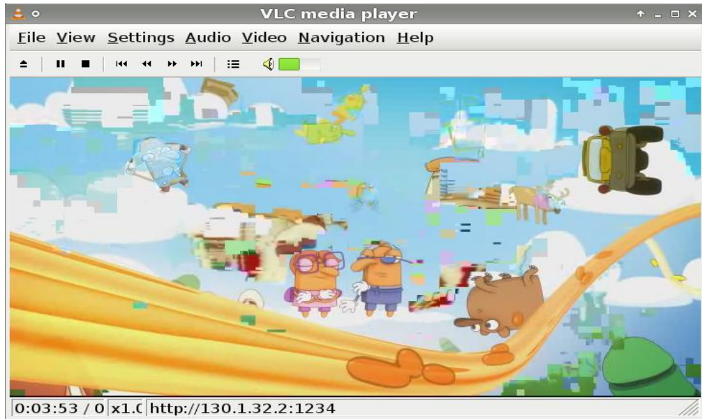
Kuva 13. Videoliikenteen testaus 3 % pakettihäviöllä.
