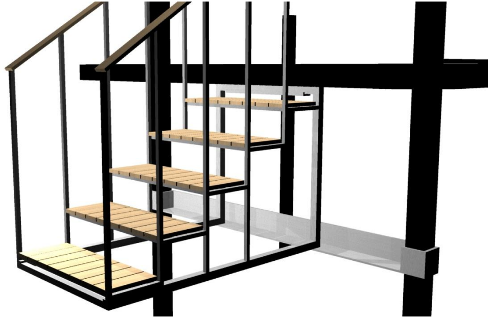
Kuva 39. Loivien portaiden tukimekanismi
