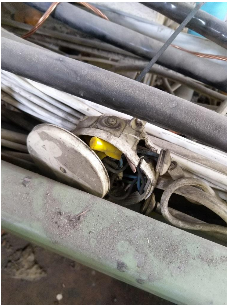
Kuva 1. NK1 kopin p ae ll ae hyllyss ae pahasti rikkoutunut jakorasia
