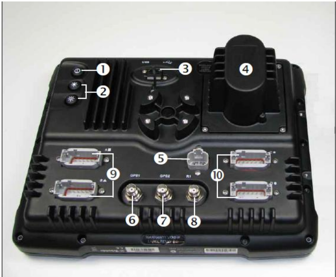
Kuvio 2. Trimble FmX näytön liitännät. (FmX, [viitattu 09.03.2011].)
