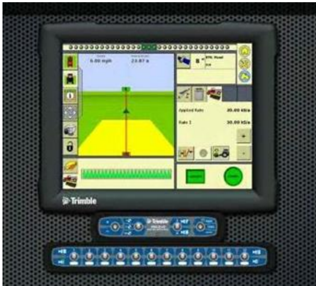
Kuvio 5. FieldIQ käyttöyksikkö sekä venttiilikohmainen manuaalihallinta. (FieldIQ, [viitattu 12.02.2011].)
