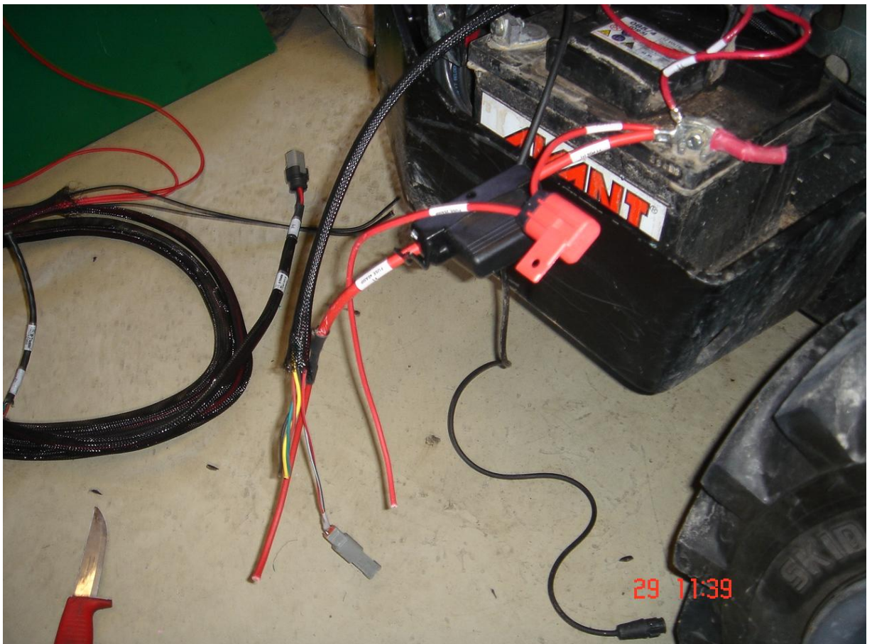
Kuvio 10. Johtosarjat katkaistuna Avantin puolella.
