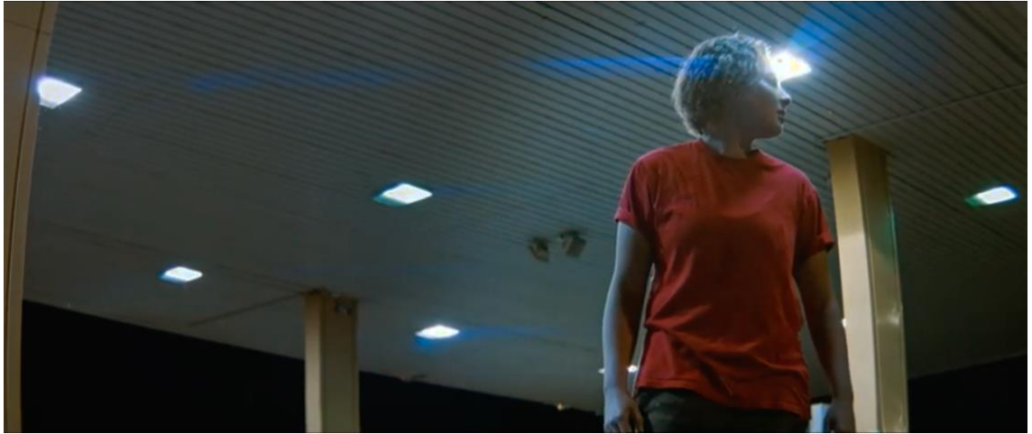
Kuvio 9. SLR-Magicin 1.33x-anamorfinen linssi. Flare on selkeästi erilainen kuin 2x-anamorfisissa linseissä. Kuvan reunoilla on tynnyrimäistä vääristymää. Tätä ei välttämättä ole laadukkaissa anamorfisissa linseissä, vaan on edullisimpien anamorfisten linssien ominaisuus. Lisäksi on myös kyse laajan linssin tynnyriefektistä. Kuvakaappaus kuvaamastani musiikkivideosta.
