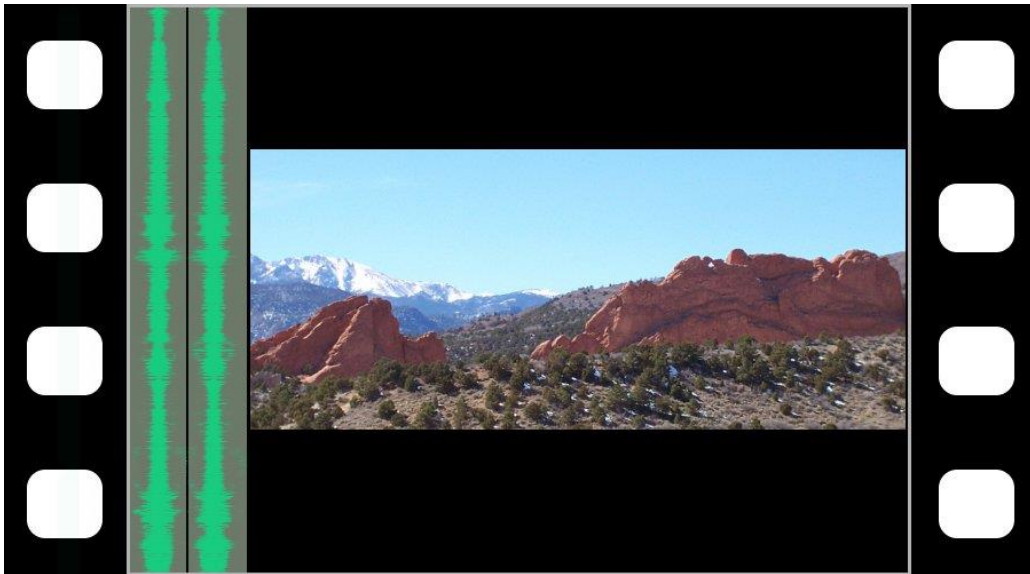
Kuvio 2. Sfäärisellä linssillä kuvattua materiaalia filmille laajakuvana. Kuvan ylä- ja alareunassa ei tallennu informaatiota filmille, jolloin osa filmistä jää ikään kuin käyttämättä.
