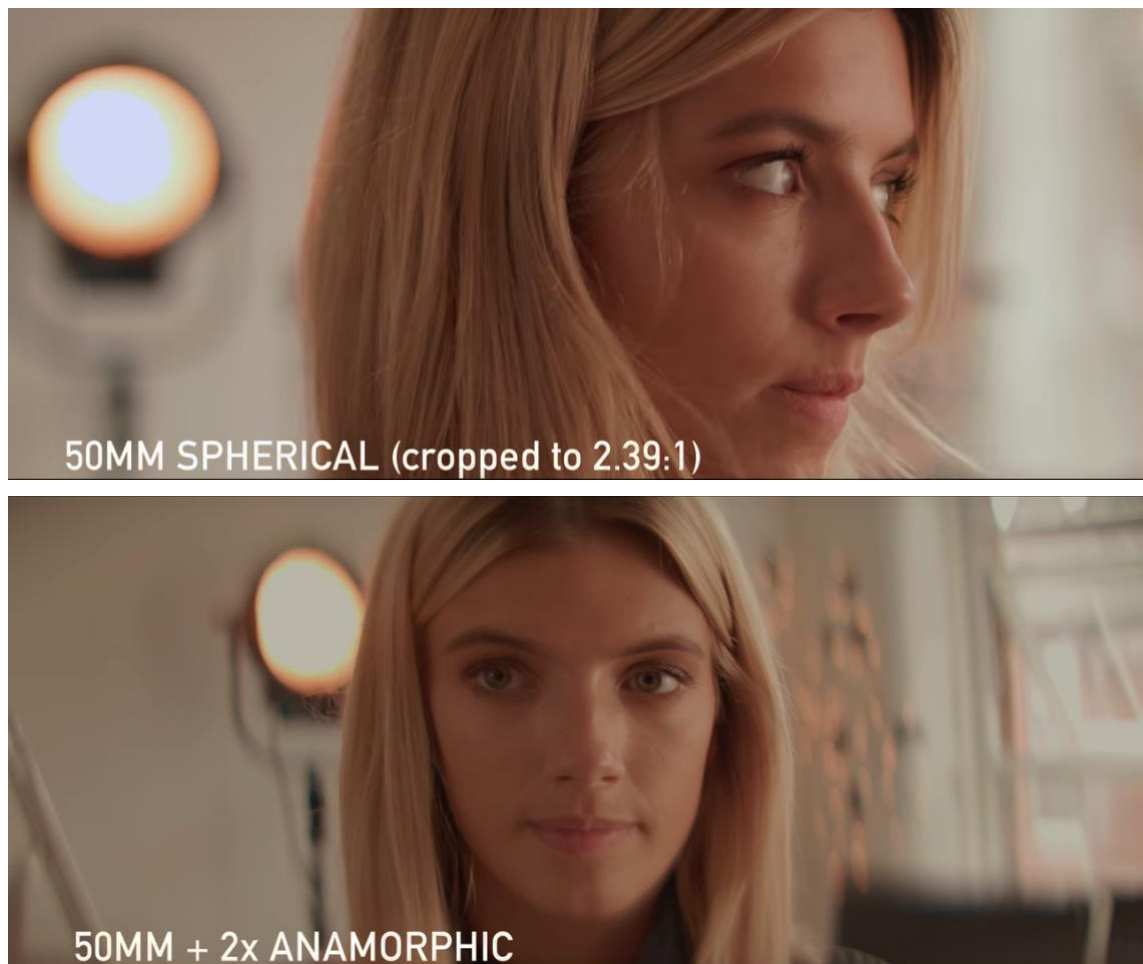
Kuvio 11. Alemman kuvan anamorfinen linssi näyttää enemmän informaatiota kuin ylhäällä oleva sfäärinen linssi. Sfäärisen linssin materiaali on rajattu anamorfiseen kuvasuhteeseen. Anamorfisella linssillä kuvatussa kuvassa myös lamppu on ovaalin muotoinen. Kuvakaappaus Youtubesta käyttäjän Ben Saffer videosta.
