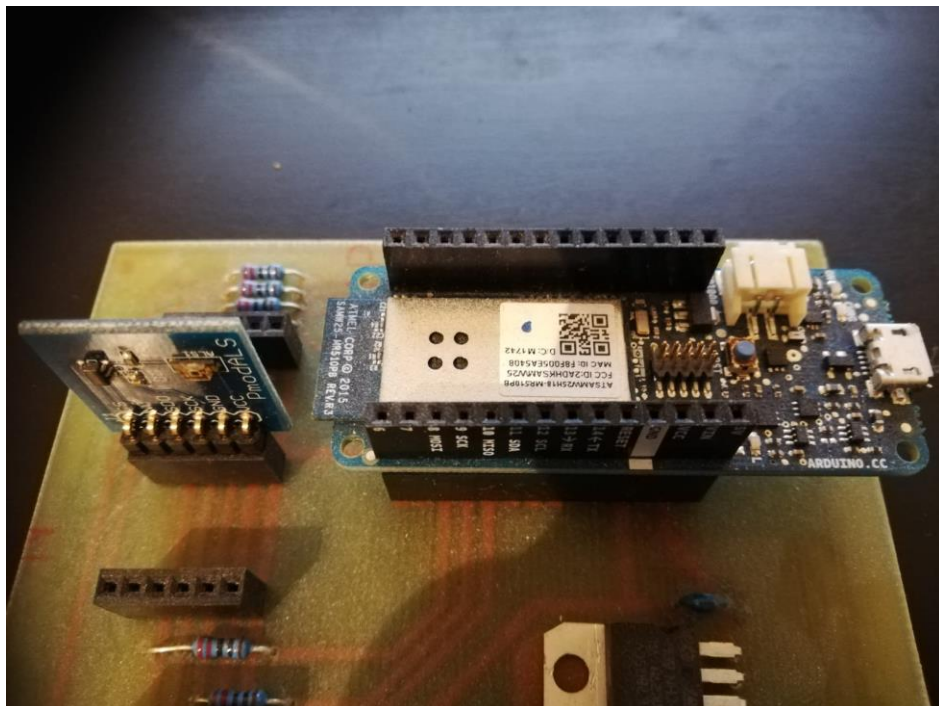
Kuva 1. Taustavalosensori ja Arduino MKR1000
