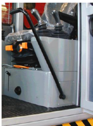
Kuva 16. Turvakahvan toiminta PMx24-koneen käyttöohjeesta. (Junttan Oy, 2019)
