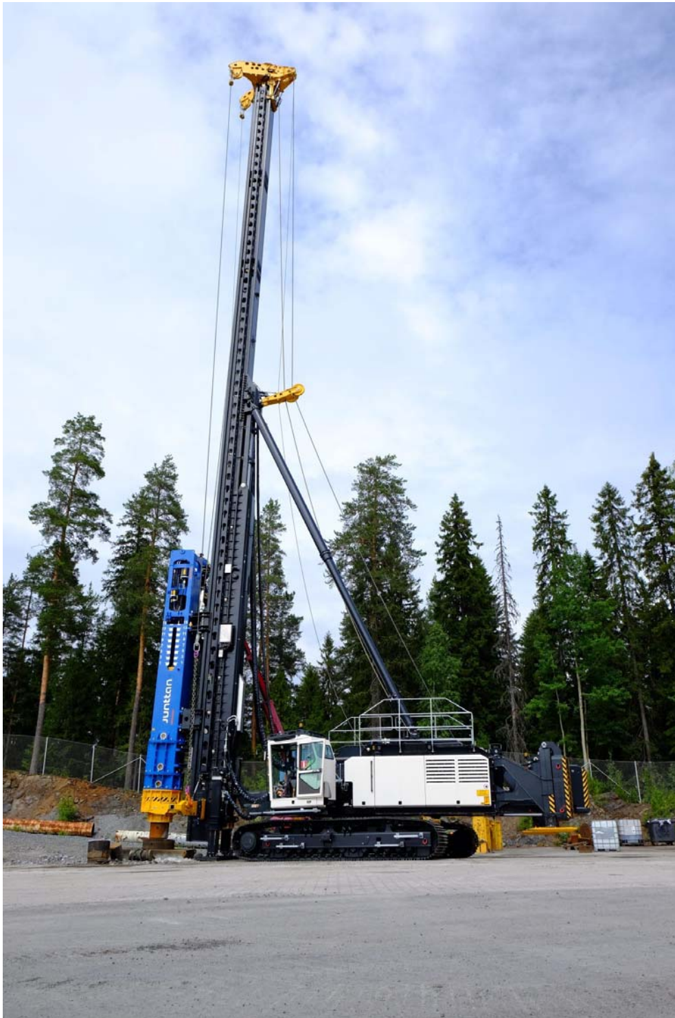
KUVA 1. MPx90 – Multipurpose paalutuskone. (Junttan Oy, 2019)
