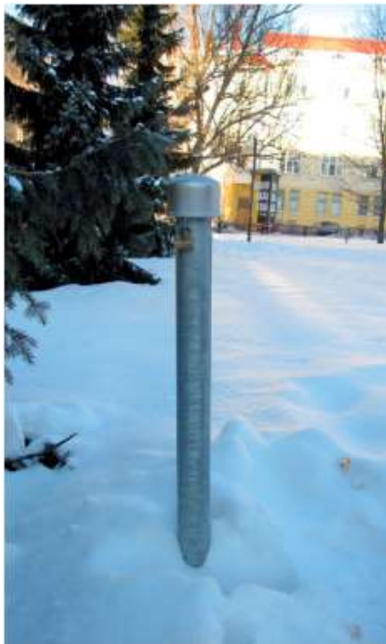
Kuva 11. Pohjavesinäytteitä voidaan ottaa pohjavesiputkesta [39, s. 52].
