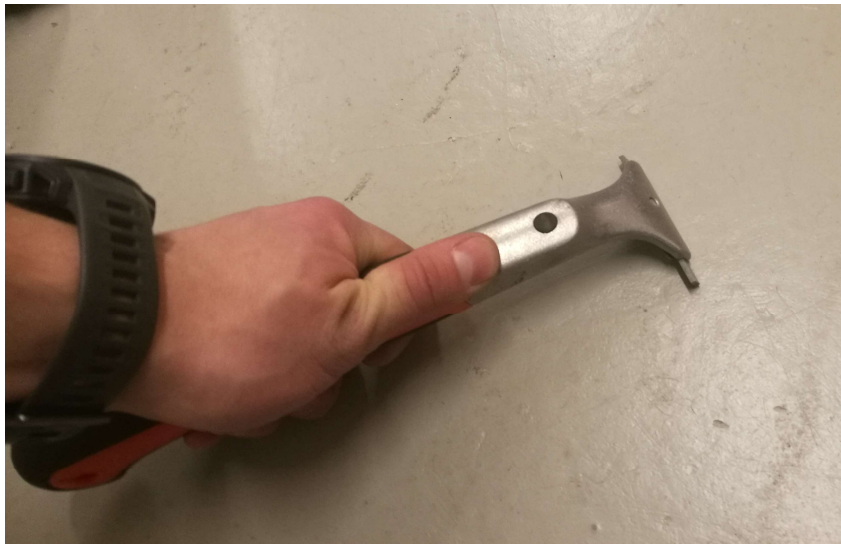
Kuva 7. Maalinäytteitä voidaan kerätä maalihöylällä.
