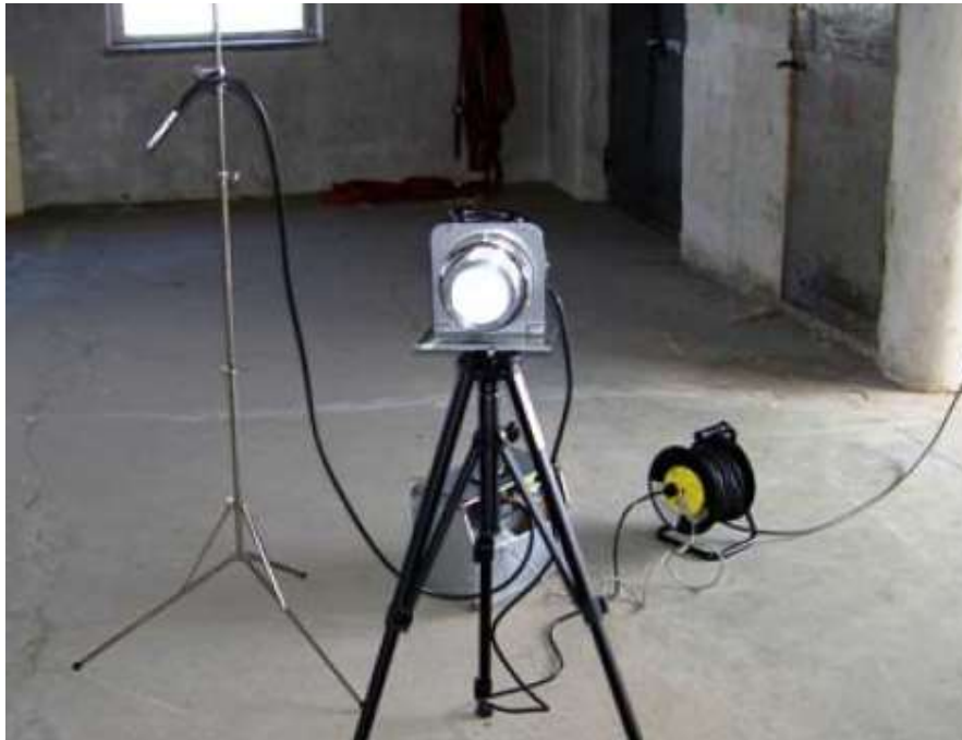
Kuva 9. Ilmanäytteen keräämiseen käytettävää laitteistoa, etualalla suurtehopölynkeräin lasikuitusuodattimella, vasemmalla statiiviin kiinnitettynä XAD-keräin kaasumaisia yhdisteitä varten, joka on kytketty takana olevaan harmaaseen REC-pumppuun [11, s. 31].
