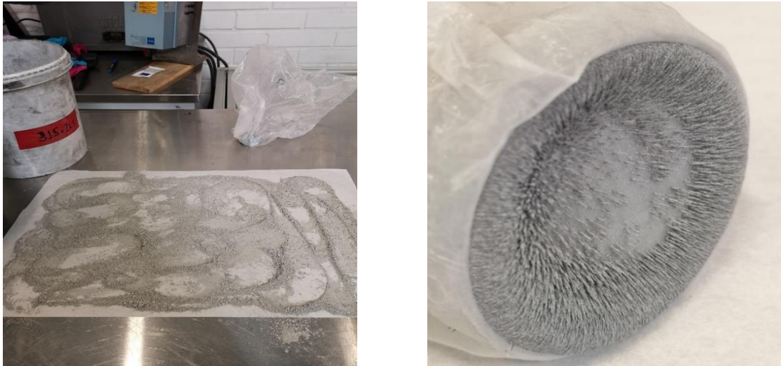
Kuva 11. Kuona-ainesta magneetilla seulottu (vasen). Metallinen materiaali tarautunut magneettiin, joka on suojattu pussilla (oikea).
