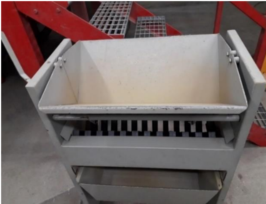
Kuva 2. Kahtiointilaitteessa näyte voidaan sekoittaa ennen sen jakamista (Hyttiinen 2019).
