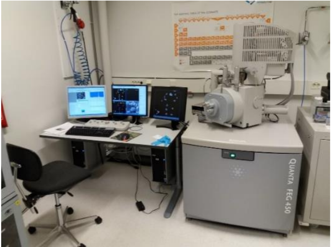
Kuva 9. EDS -laitteisto näyttöjen oikealla puolella ja sen alapuolella Quanta FEG450 -elektronimikroskooppi.
