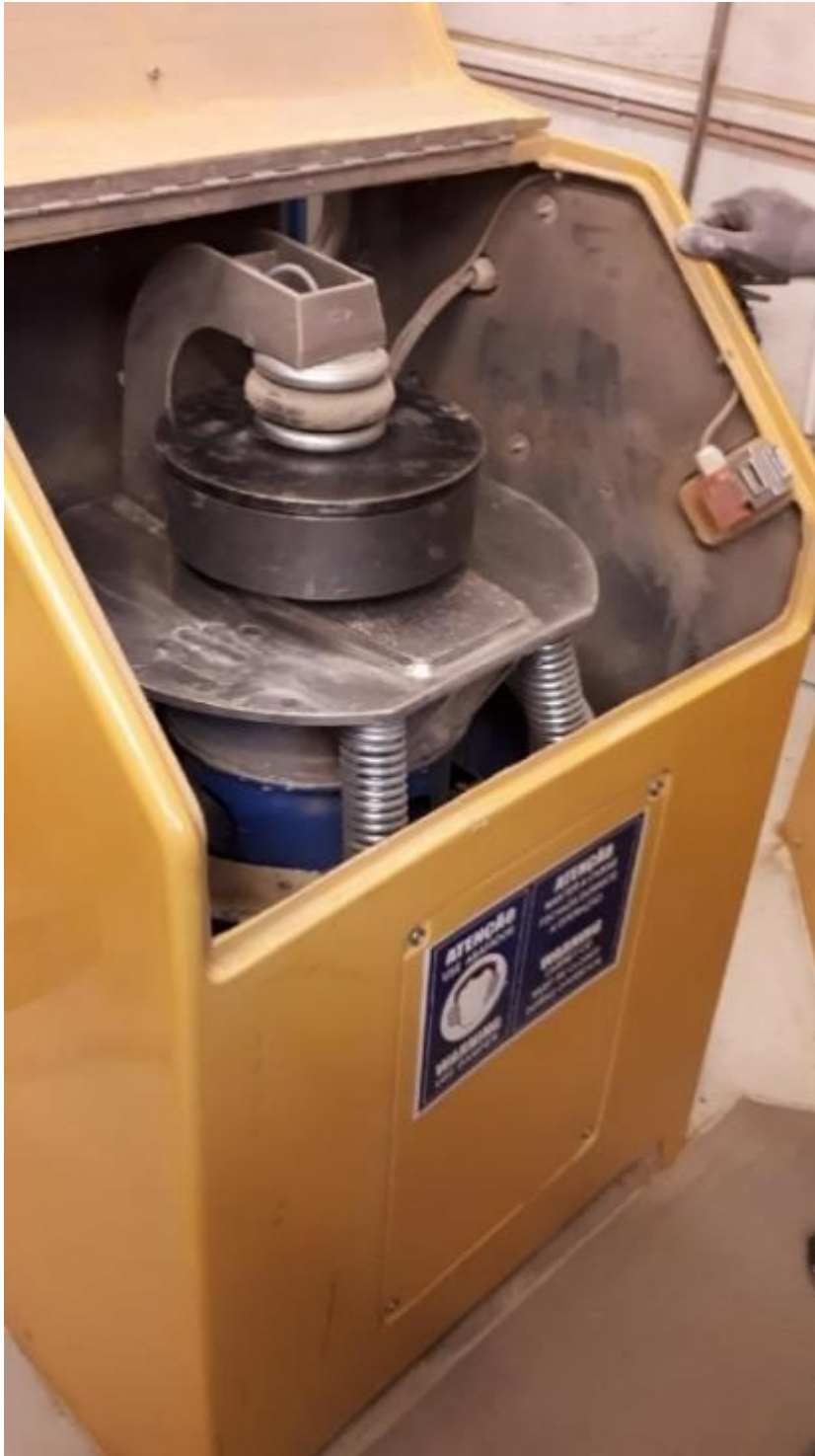
Kuva 6. Epäkeskon pyörivä liike liikuttaa padan sisällä olevaa jauhinkiekoa, joka jauhaa näytettä iskeytyessään padan seinämiin.
