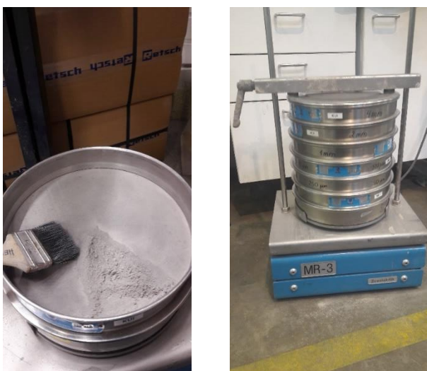
Kuva 7. Pensselöintiä seulaverkon päällä (vasen). Scanteknik-MR3 -täryseula (oikea).
