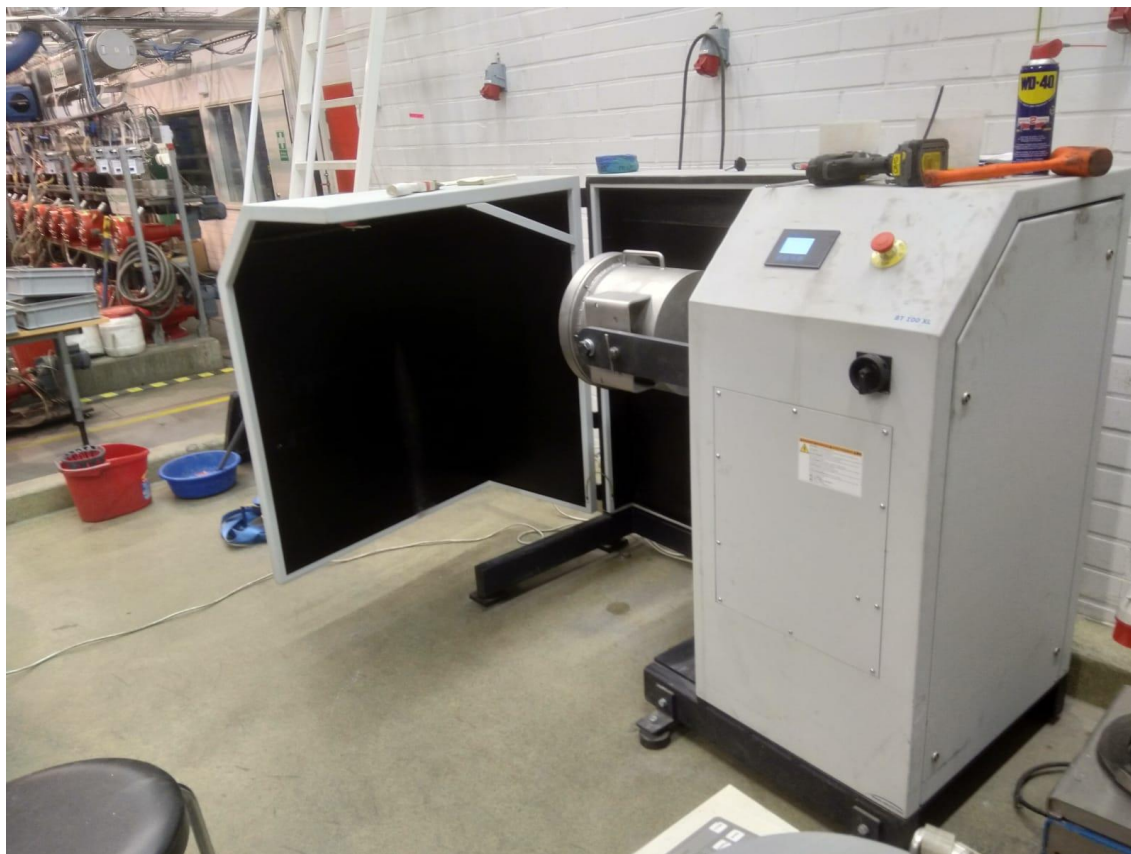
Kuva 4. Bond-mylly, missä sylinteri on lukittuna jauhusasentoon.
