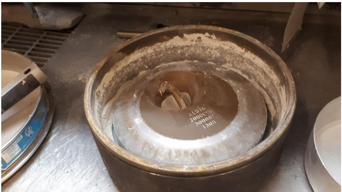
Kuva 5. Swing-mylyn pataa ja jauhinkiekkkoa saa eri materiaaleilla, kuten karkeasta kromiteräksestä. Padan materiaali valitaan näytteen vaatimuksien mukaan.
