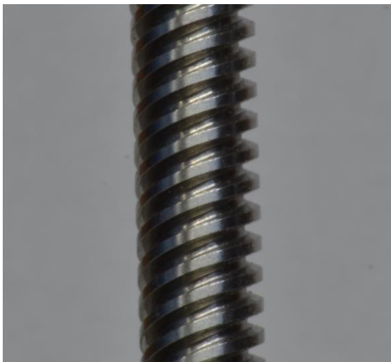
Kuva 10. Yleisin käytetty kierretanko eli trapetsiruuvi
