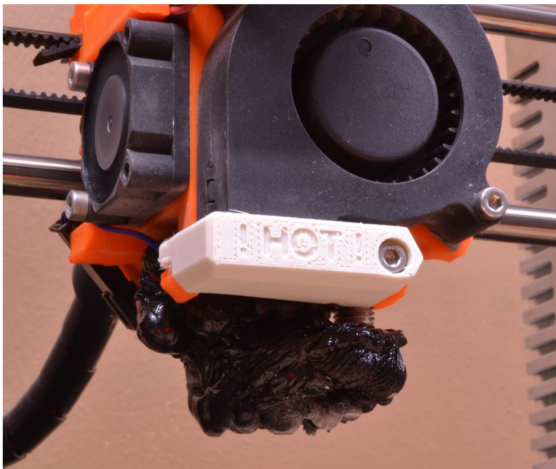
Kuva 35. Tulostimen suutinpäähän tarrautunut yli puolet tulosteen muovista tulostuspedistä irronneen tulosteen vuoksi
