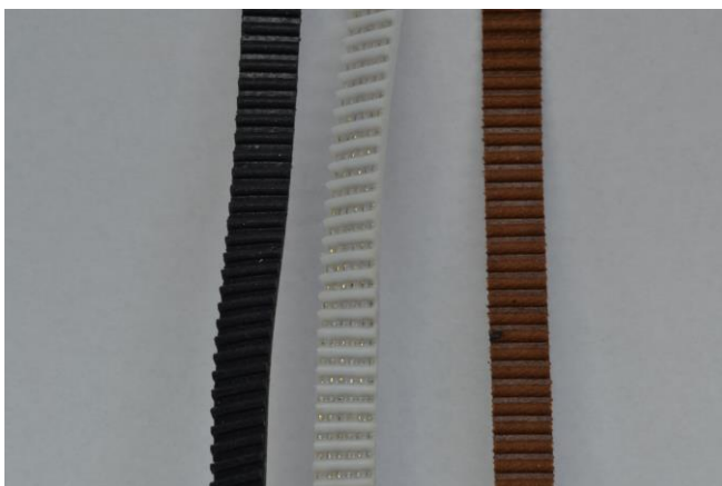
Kuva 9. Kolme erilaista hihnaa; halvin, peruskumihihna, metallivahvistettu polyuretaanihihna, sekä kuminen lasikuidulla vahvistettu hihna
