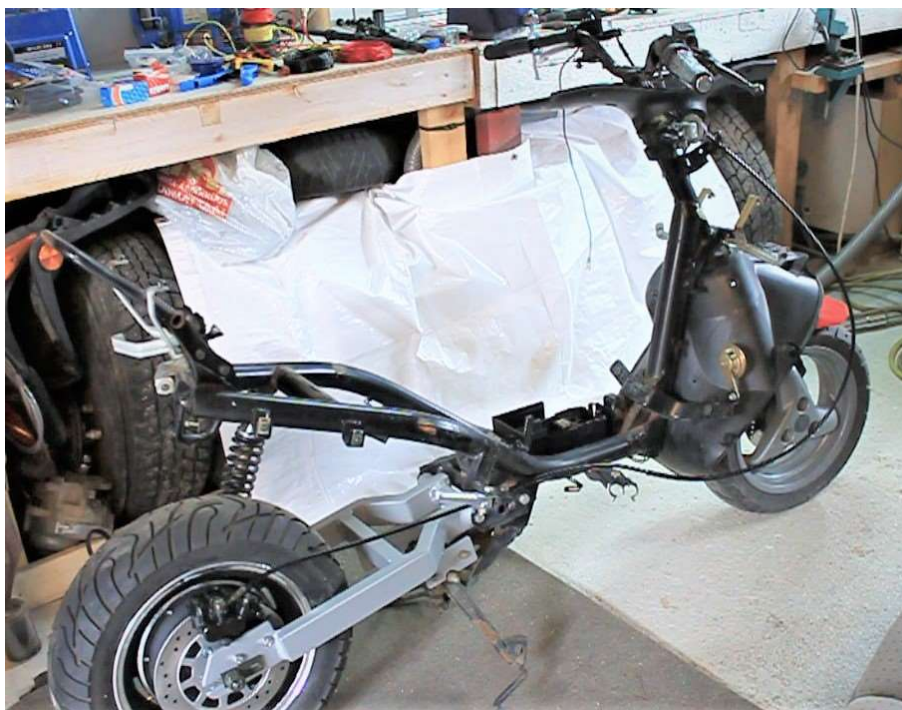
Kuva 12. Moposkooterin runko, jossa uusi takahaarukka ja moottori asennettuna
