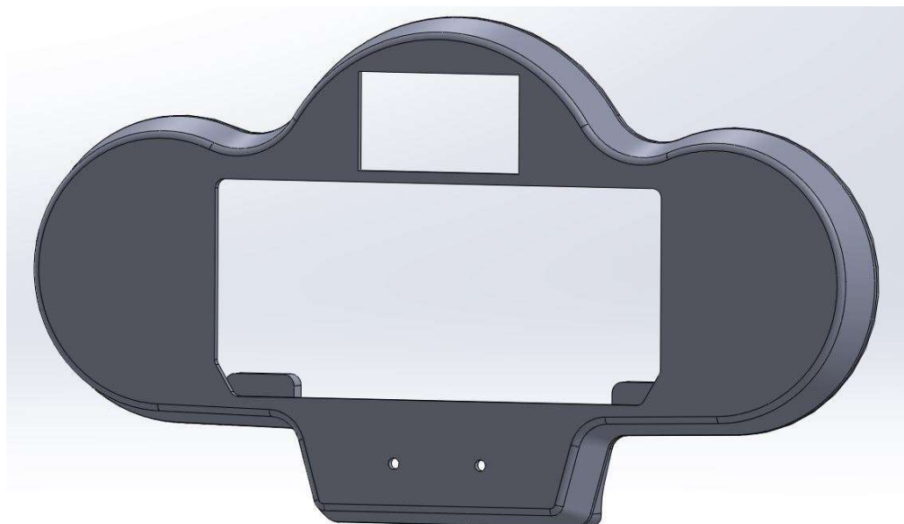
Kuva 11. Mittariston karmin 3D-malli
