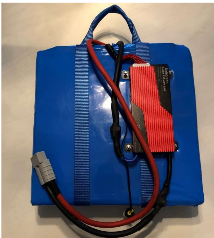
Kuva 8. Valmis akku, jonka päälle on asennettu BMS.
