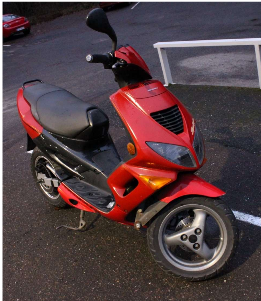
Kuva 14. Valmis sähkömoottorilla varustettu moposkootteri
