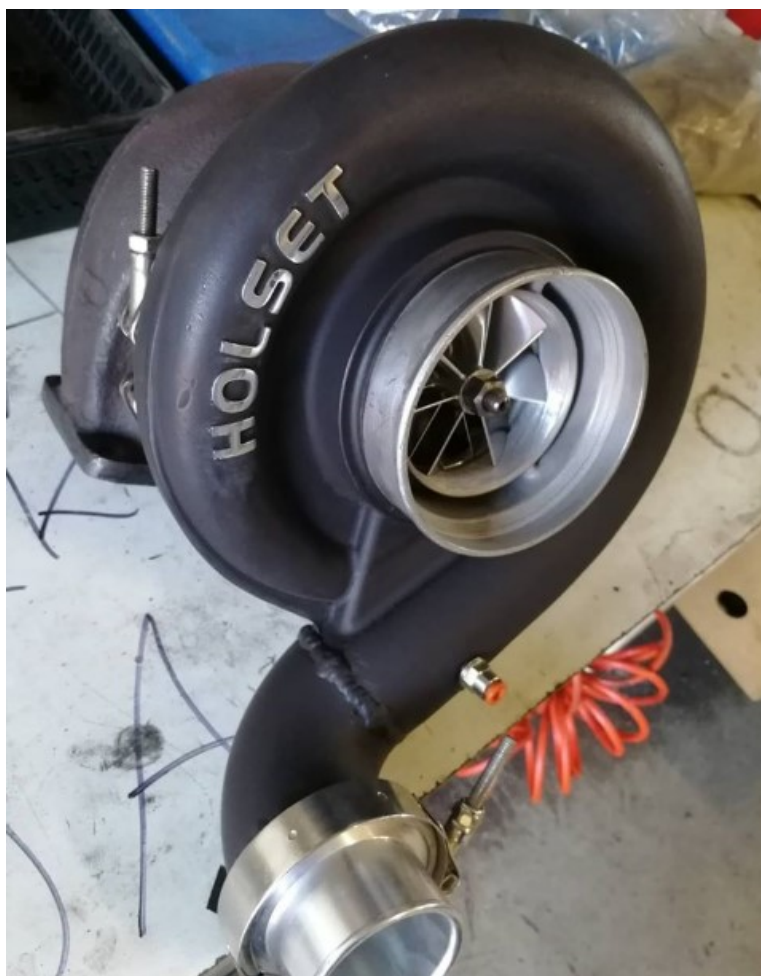
KUVA 6. Holset Pro55 -kompressorikotelo ja -kompressorisiipi.
