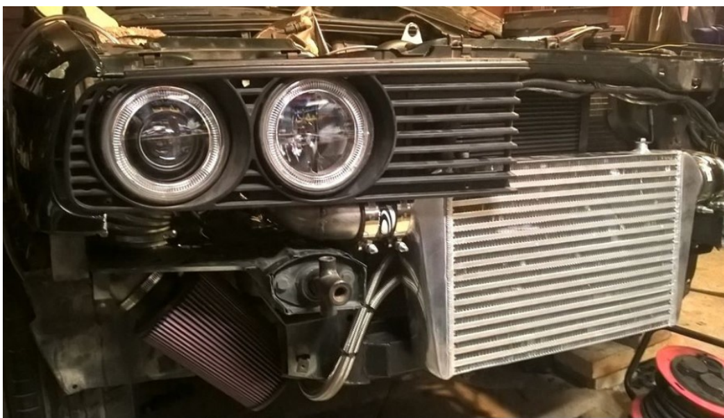
KUVA 7. Välijäähdytin asennettuna etupuskurin sisään
