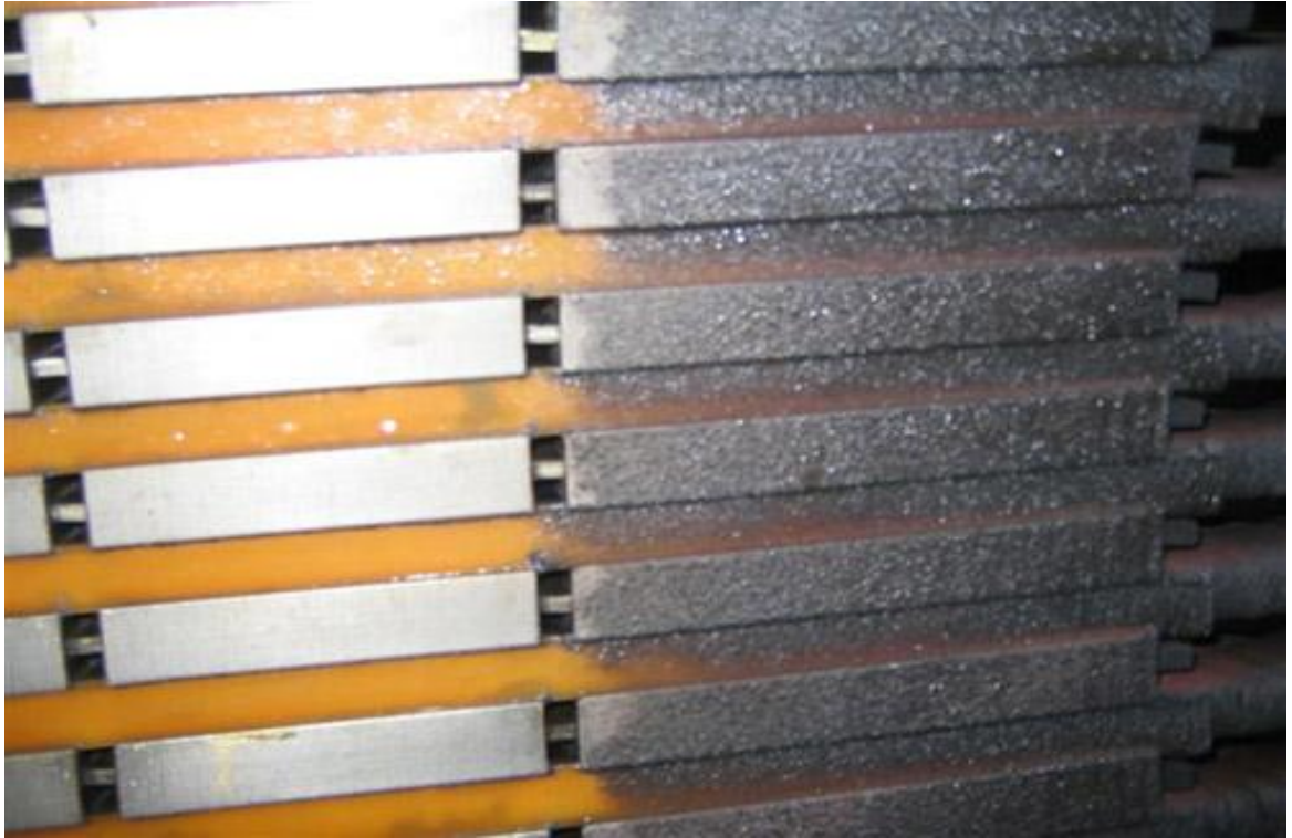
KUVIO 17. Käämitys ennen ja jälkeen puhdistusta. (Coldblasters 2010.)
