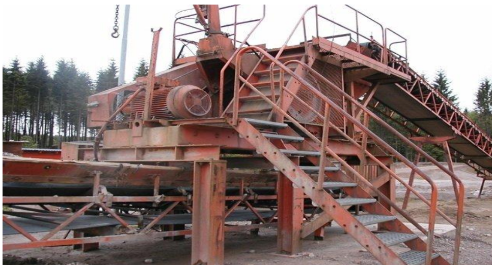
KUVIO 7. Oikosulkumoottorikäyttöinen kivenmurskain. (Alibaba 2011.)
