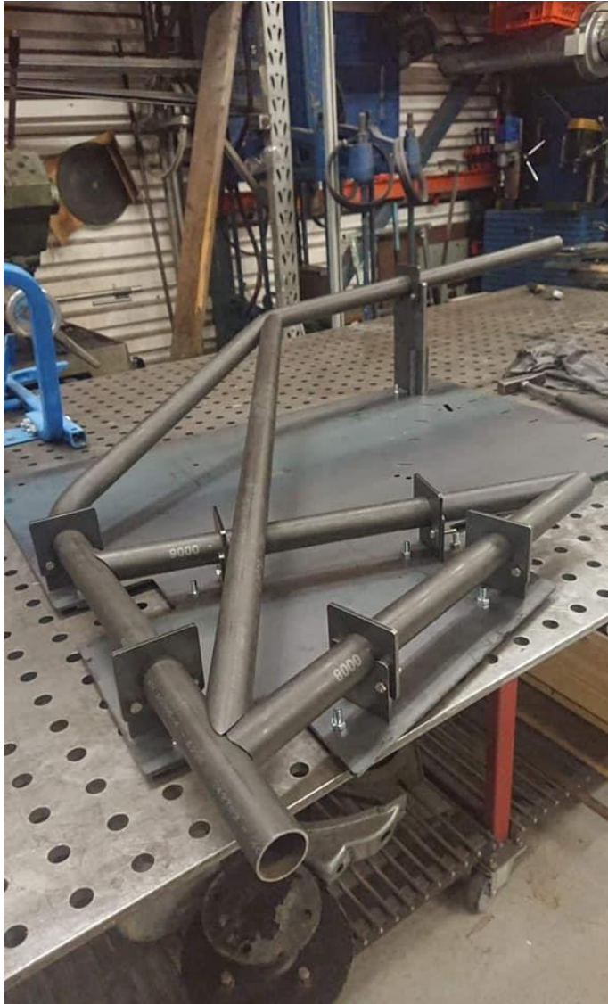
Kuva 26. Puolikaarien hitsausjigi sekä oikean puolen putket siihen asennettuina
