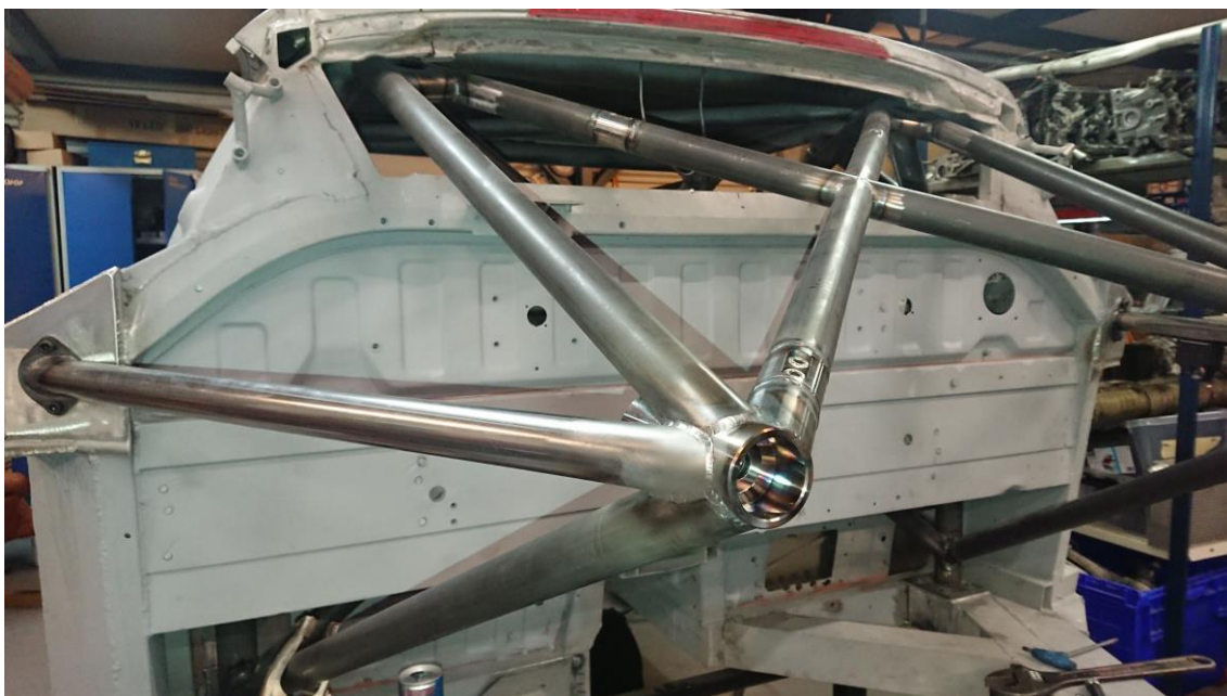
Kuva 33. Takarungon yläpään kiinnitys turvakaariin
