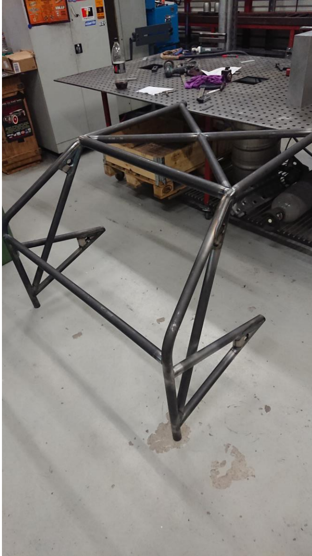
Kuva 27. Puolikaarien, poikittaisten tukiputkien sekä kattoristikon sovitus
