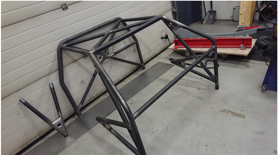
Kuva 31. keskenään sovitettut turvakaarien osat
