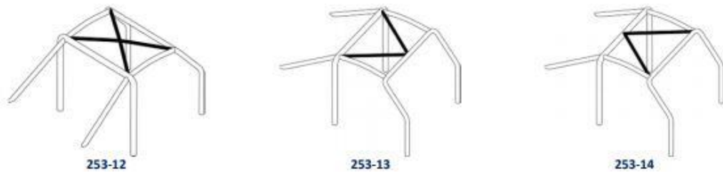
Kuva 12. kattorakenteen tuenta FIA sääntö 8.3.2.1.3 (FIA Appendix J)
