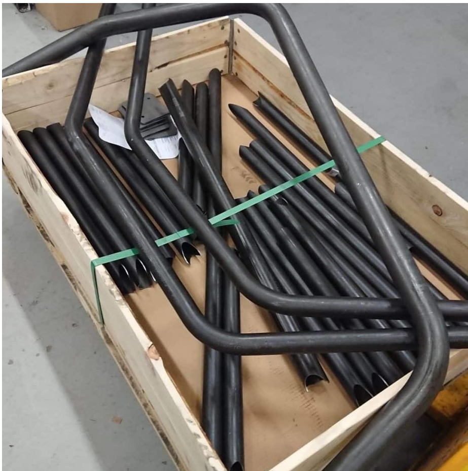
Kuva 25. Laserleikatut sekä NC-taivutetut turvakaariputket
