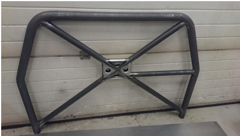
Kuva 30. Valmis pääkaari tukineen
