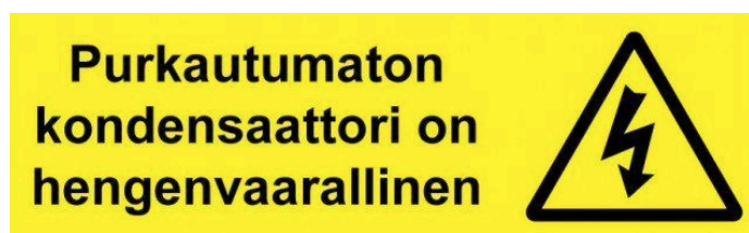
KUVA 5. Kondensaattorista varoittava kilpi (Turvamerkki, purkautumaton kondensaattori n.d.)
