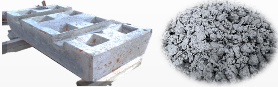
KUVA 30. BETONIBLOKI JA STABILOITU BETONIMURSKKE.
