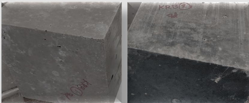
KUVA 36. OPC- JA GEOPOLYMEERIBETONIKUUTIO.
