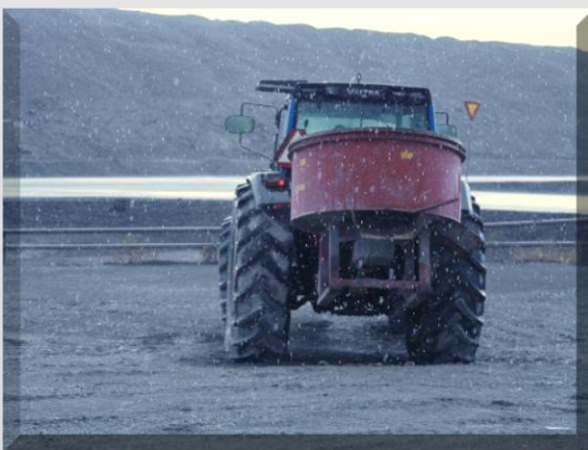
KUVA 7. MASSA SIIRRETTIIN TRAKTORILLA VALUPAIKALLE.
