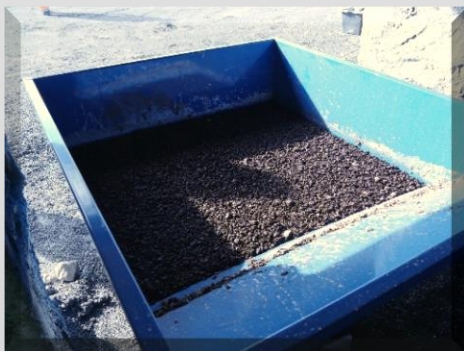
KUVA 1. KR-ALITE, JOHON ON SEKOITETTU RESEPTIN 2 ALKALILIUOS.
