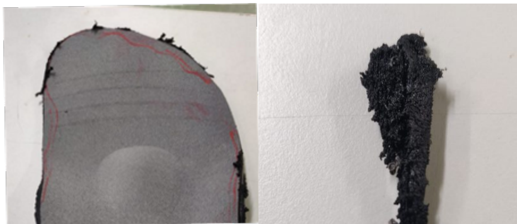
Kuvio 9. Viimeistelyä vailla oleva tukipohjallinen (vas.). Sulanutta muovimateriaalia (oik.).
