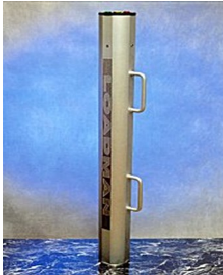
Kuva 19. Kannettava Loadman -kevyt pudotuspainolaite (AL-Engineering Oy, 2016).
