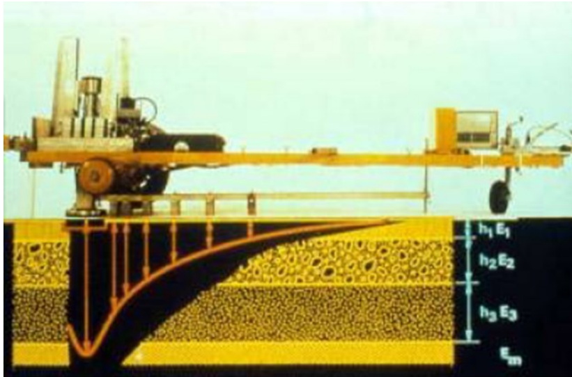
Kuva 21. KUAB -pudotuspainolaitteen taipumasuppilo (Liikennevirasto, 2011, s. 29).
