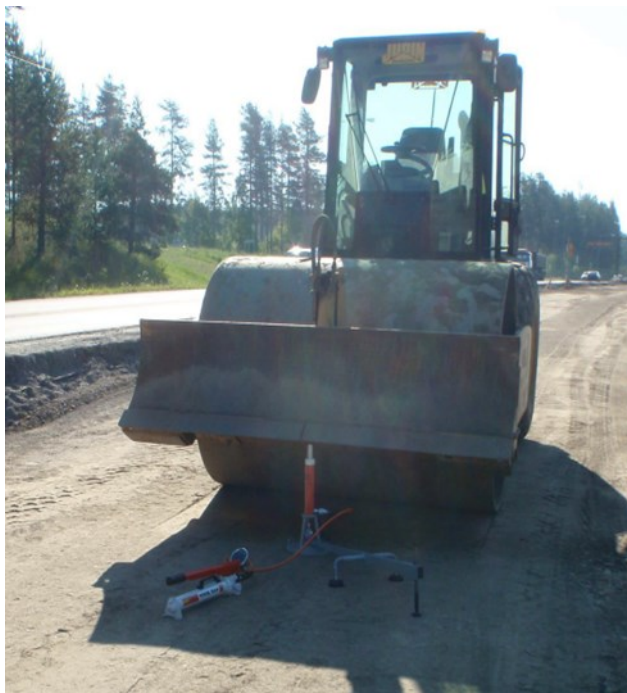
Kuva 17. Levykuormituskoe yhdellä mittakellolla (Kiiskinen, 2013, s. 20).
