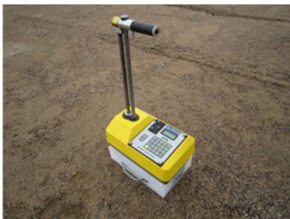
Kuva 13. Troxler 3440- säteilymittauslaite ja referenssilohko (Hämäläinen, 2011, s. 16).
