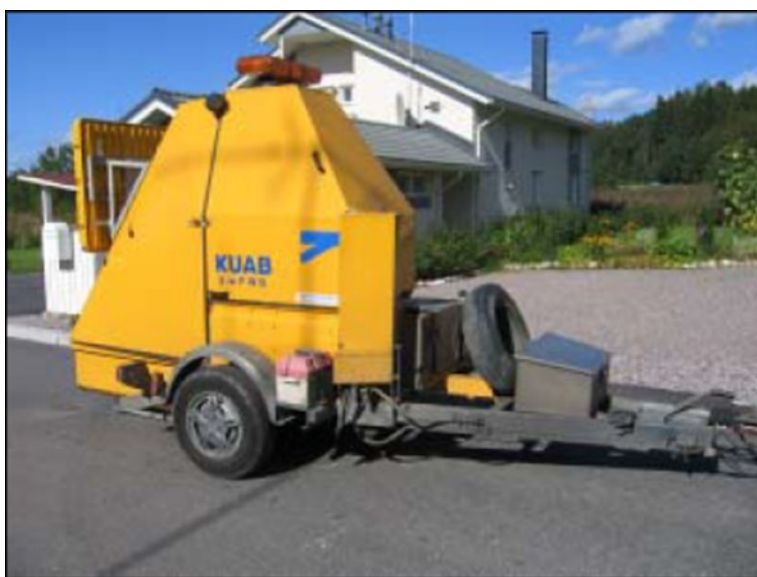
Kuva 20. KUAB -pudotuspainolaite (Siika, 2006, s. 21).
