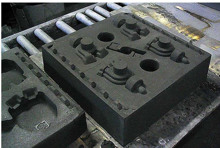
KUVA 3. Hiekkamuotin puoliskot (Reliance foundry 2019.)
