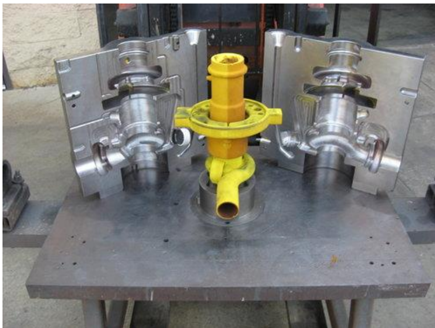
KUVA 3. Hiekkamuotin puoliskot (Reliance foundry 2019.)
