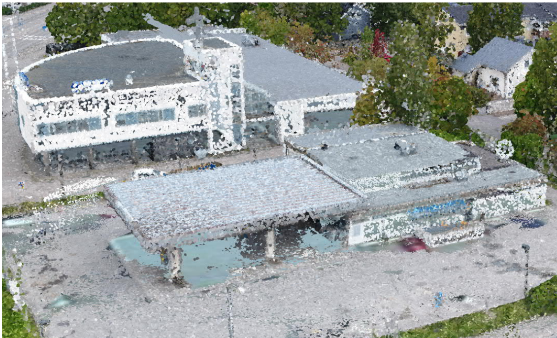
Kuva 20. Järvenpään ja Keravan yhteisellä RPAS-laitteella tuotettu pistepilviaineisto tuotuna global-ympäristöön. Copyright Järvenpään kaupunki.
