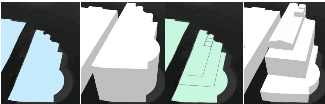
Kuva 28. Rakennusalueen korjauksen vaikutus kattomuodon oikeellisuuteen. (Pajukoski ym. 2017: 12-13)
