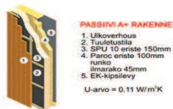
Kuva 9. Passiivitalon ulkoseinärakenne
