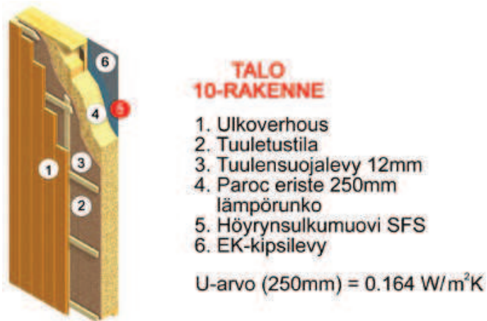
Kuva 6. Matalaenergiatalon ulkoseinän rakenne.
