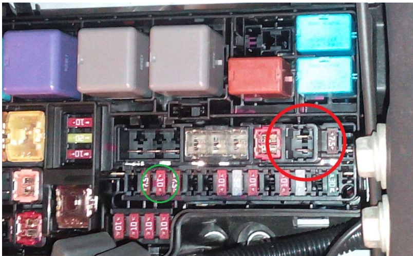
Kuva 8. H-LP MAIN- (punainen ympyrä) ja HORN-sulakkeen (vihreä ympyrä) sijainti konehuoneen rele- ja sulakerasiassa.
