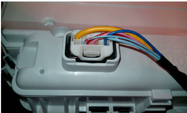
Kuva 7. Liitin G11 mittariston takana. Pinnin 7 johdin on liittimessä oikealla alhaalla oleva tumman sininen.
