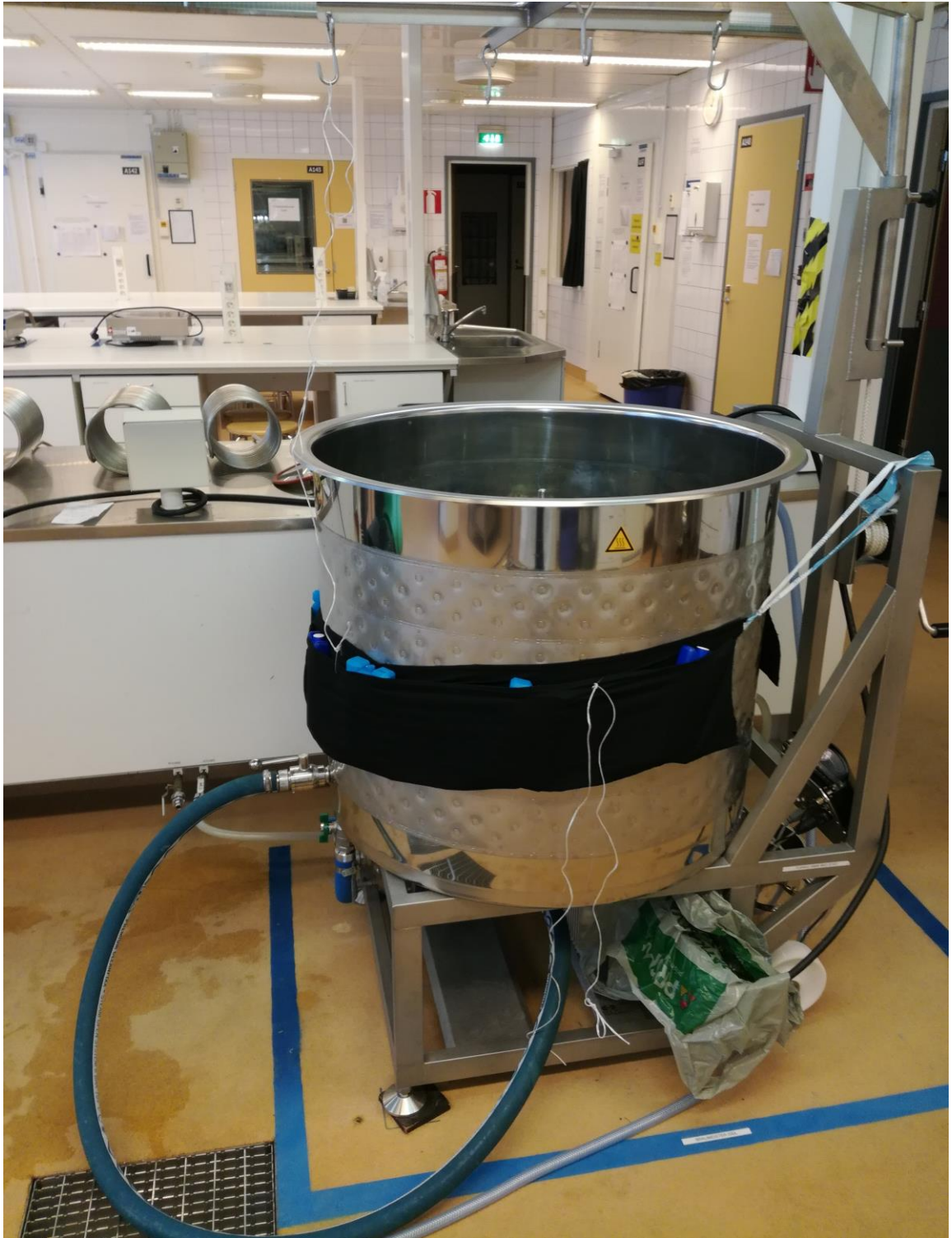
Kuva 8. Kylmäpatjat kokeilussa säiliön ympärillä.
