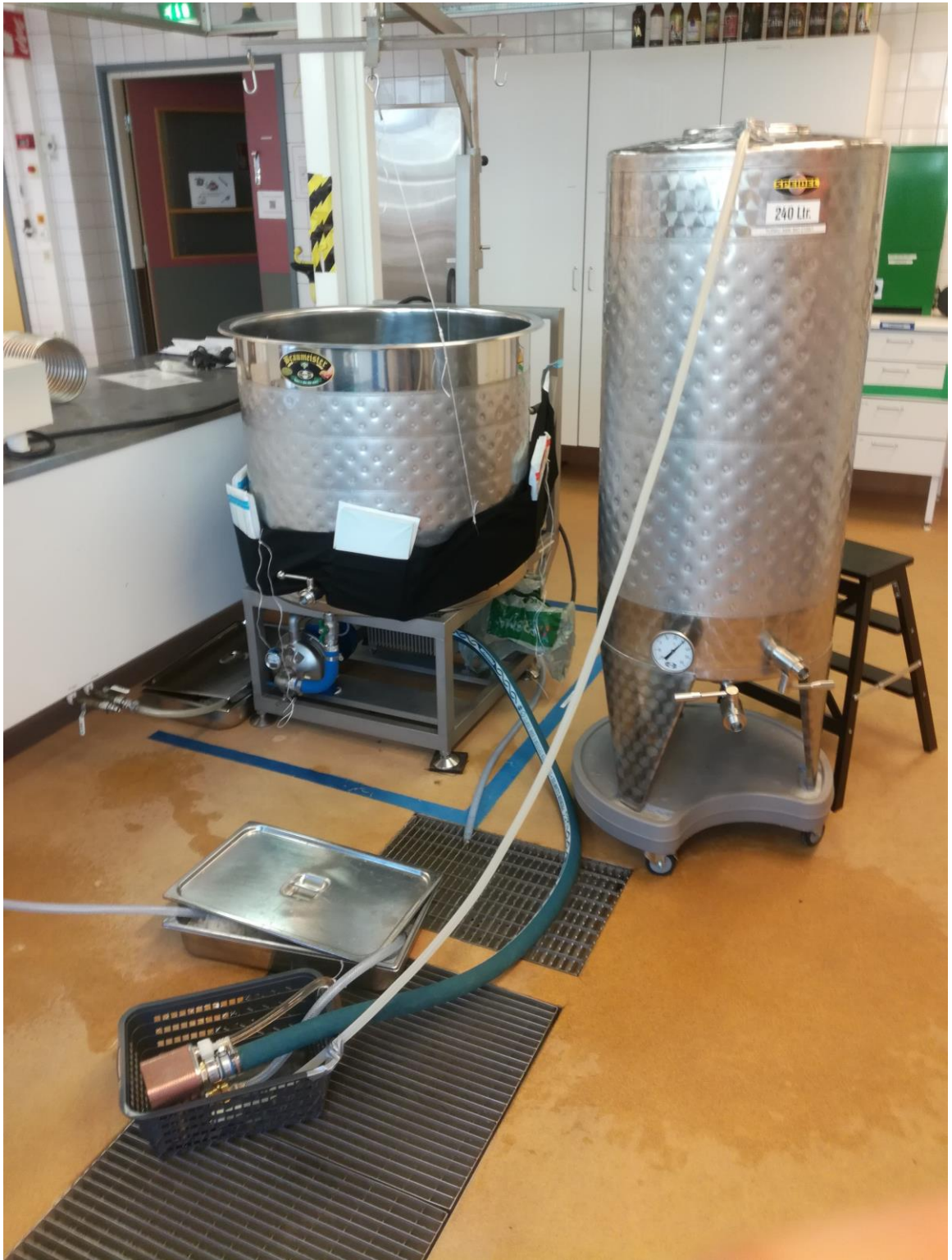
Kuva 9. Pumppaus levylämmönvaihtimen kautta fermentoriin.
