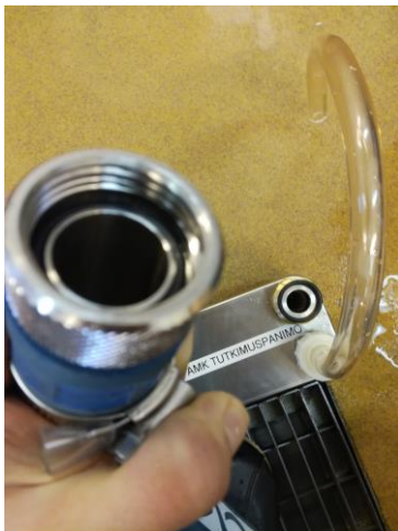
Kuva 6. Kaksi O-rengasta käytössä tiivistettäessä levylämmönvaihtimen kytkentää laitteistoon.
