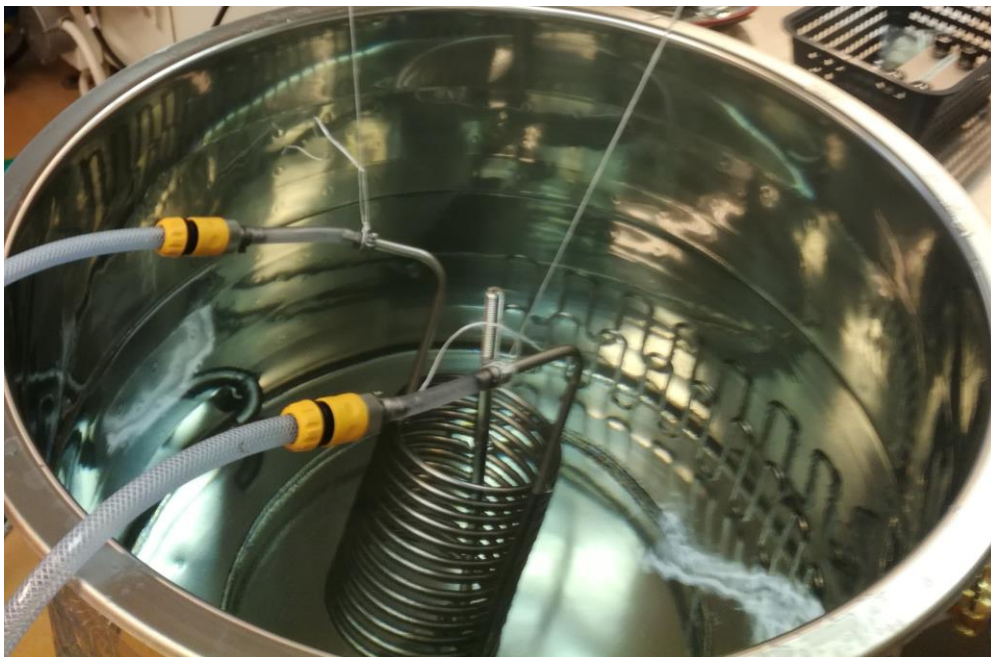
Kuva 2. Upotettava Braumeister 20 L -laitteiston vierteenjähdytin jäähdyttämässä Braumeister 200 L -laitteistossa.
