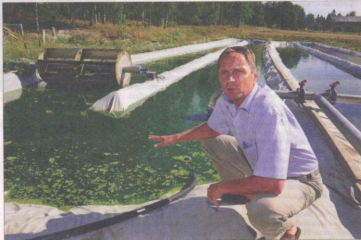
Pyöri, pyöri. Anjalan koekasvatustalokella propellit pyörittävät vettä sopivalla nopeudella levän kasvun edistämiseksi, kertoo levänkasvatushankkeen projektipäällikkö Jari Järvinen.
