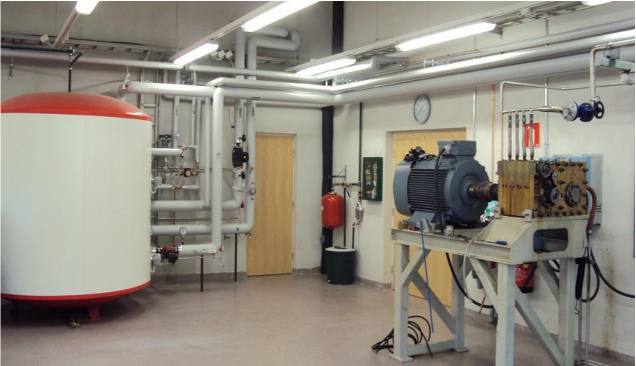
Kuva 10. Vasemmalla on lämminvesivaraaja; keskellä generaattori ja oikealla vipumäntämoottori, jota voidaan pyörittää kattilalla tuotetulla höyryllä tai vedellä.
