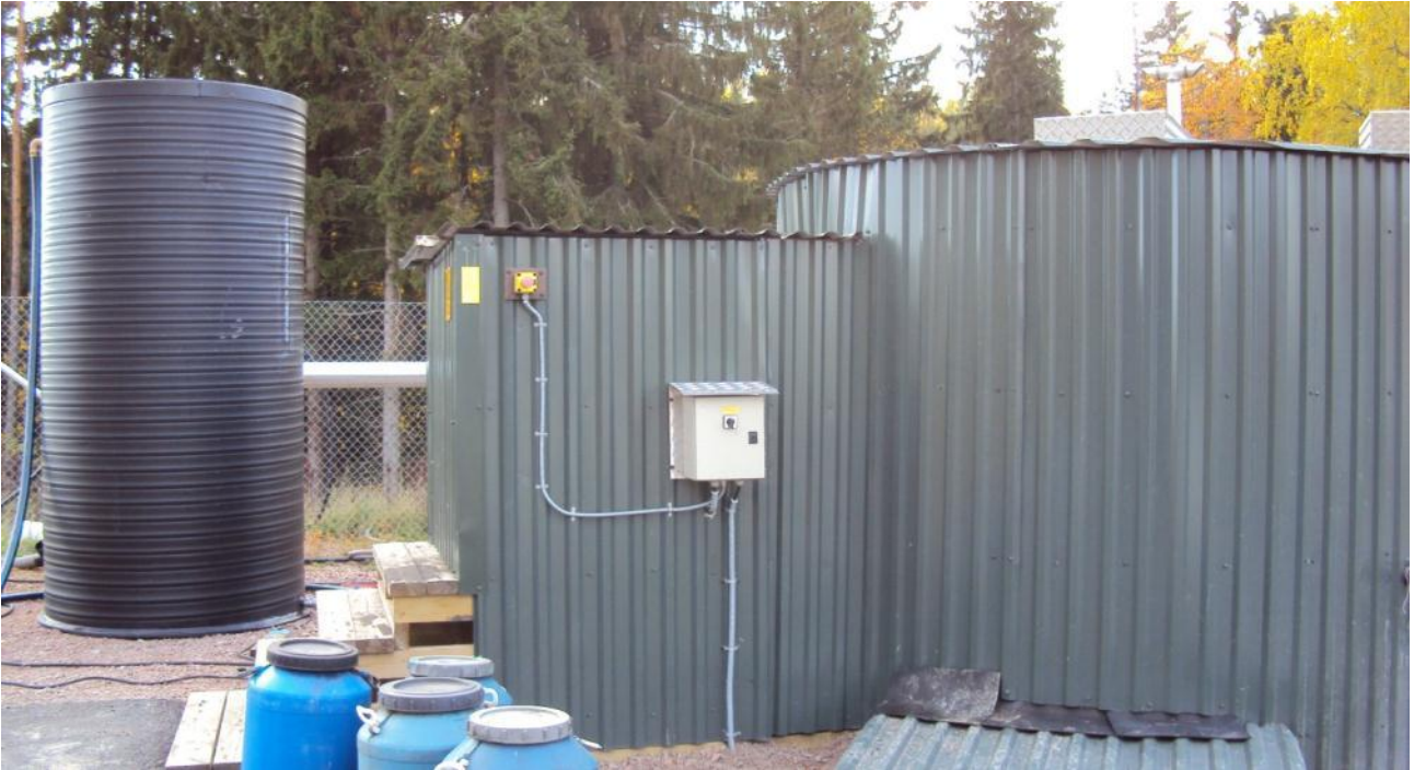
Kuva 16. Hiilidioksidin syöttö (CO 2 ) sekä levien ruokailuastia. Levät pumpataan tähän ruokailuun ja erotukseen.
