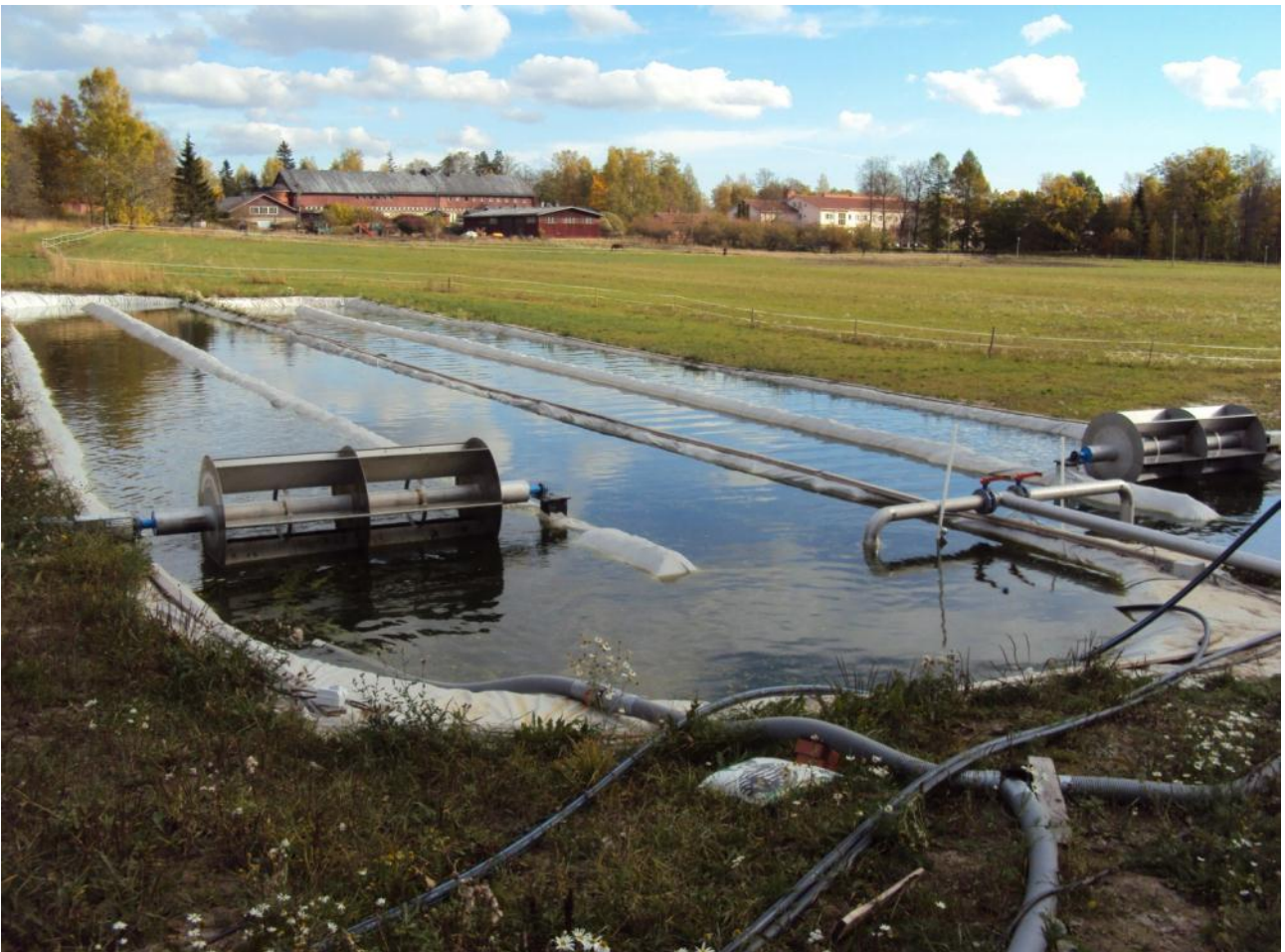
Kuva 13. Anjalankoskella oleva, kesällä 2010 käyttöön otettu levänkoekasvatusallas.
