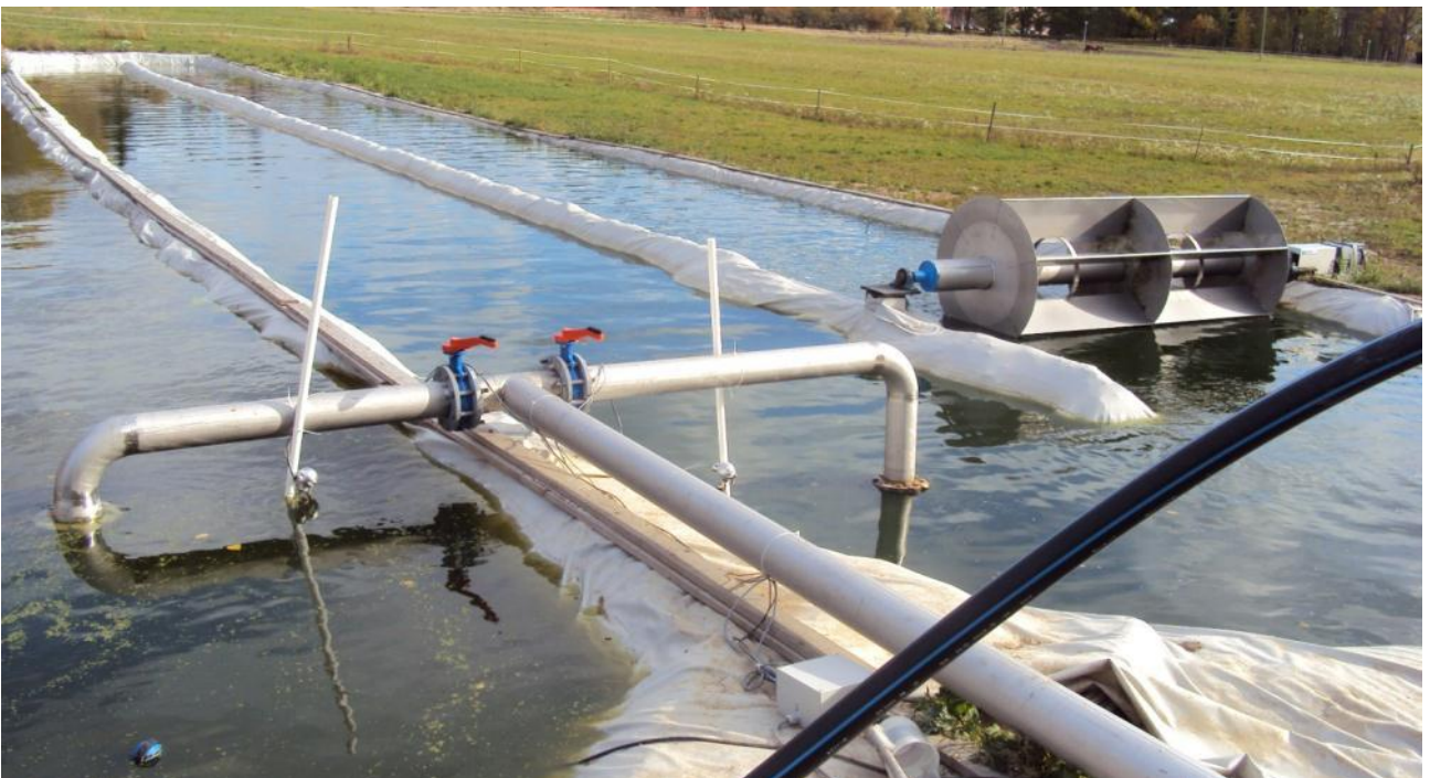
Kuva 15. Levänkeräys erotukseen ja hiilidioksidi-lannoitukseen . (CO 2 )
