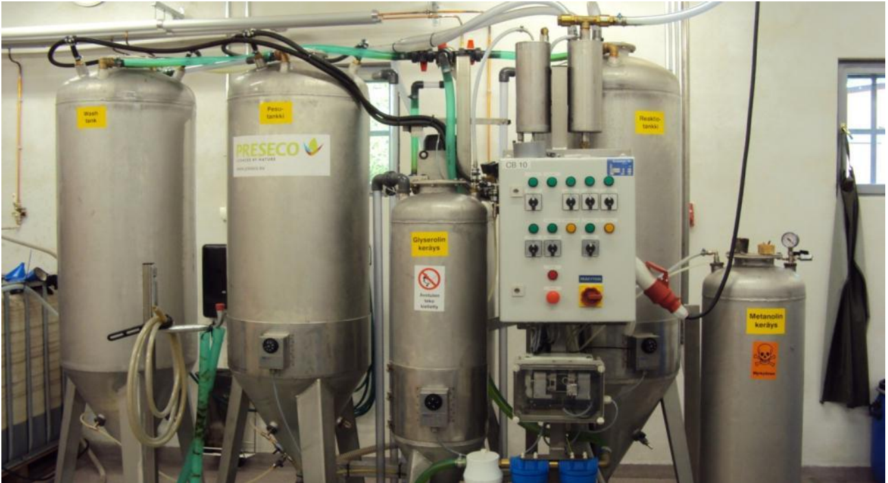
Kuva 12. Metanolin erotuslaitteisto biodieselin valmistusta varten. Vasemmalla pesutankit, keskellä glyserolin keräys, vasemmalla reaktiotankki ja metanolin keräys.
