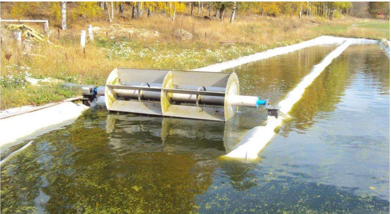
Kuva 16. Hiilidioksidin syöttö (CO 2 ) sekä levien ruokailuastia. Levät pumpataan tähän ruokailuun ja erotukseen.
