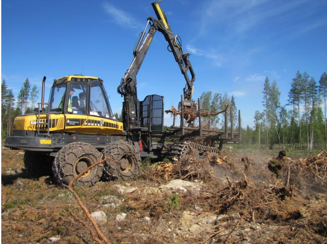
KUVA 4. Kannot tienvarteen ajoi Ponsse Elephant, jossa oli lisänä kuormatilaan laitettavat 'putkisermi' (Raitila 2010).
