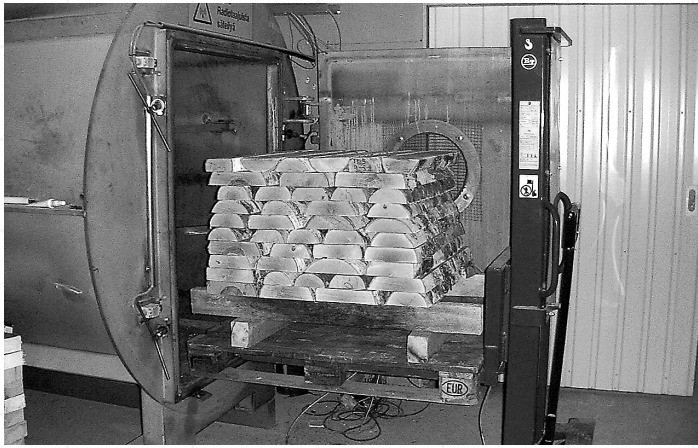
Kuva 1. Läpisahatun koivun koekuivaus HFV-kuivaamossa. (Kuva: Jari Suominen)
