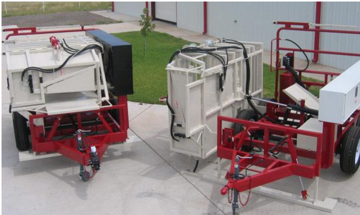
Kuva 3. Kyljelleen kääntävä sorkkahoitokärry. Tandem Axle Trailer Hoof Trimming Chute. Kuva Riley Built 2010b.
