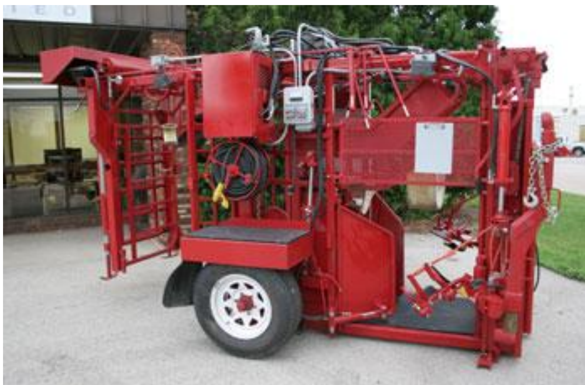
Kuva 2. Pystymallinen sorkkahoitokärry. Appleton Steel Ultra Chute. Kuva Appleton Steel 2010d.
