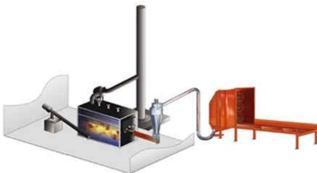
KUVIO 2. LIN-KA oljenpolttolaitteisto (Straw firing systems 200–1500 kW, 2006.)
