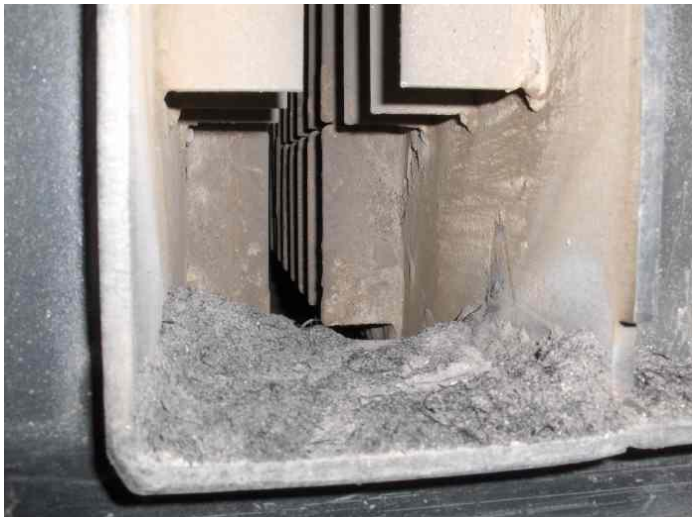
KUVIO 38. Konvektiopinnat kokeen jälkeen
