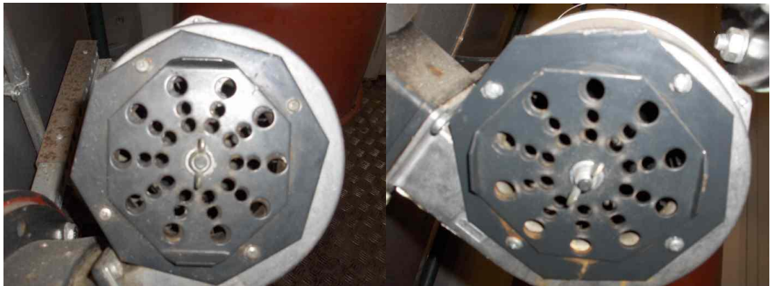
KUVIO 25. Kolmannessa polttokokeessa hyväksi havaitut ensiö- ja toisioilman säädöt
