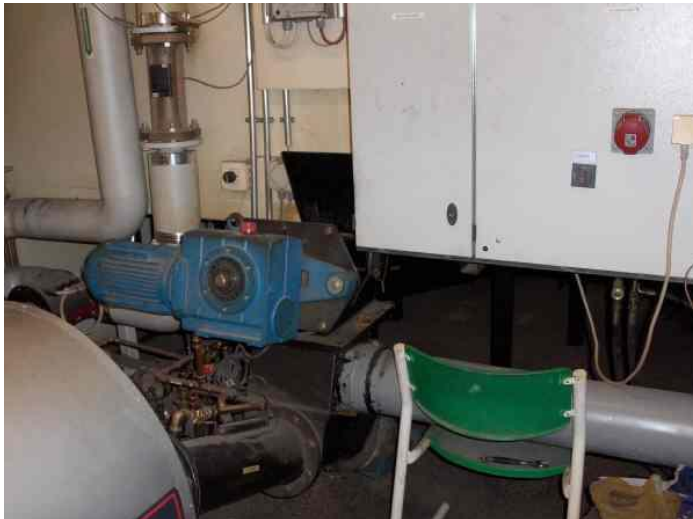
KUVIO 43. Sivusyöttölaitteen syöttöruuvi kytkettynä syöttösuppilon
