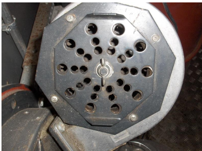
KUVIO 17. Ensimmäisessä polttokokeessa hyväksi havaittu ensiöilman säätö
