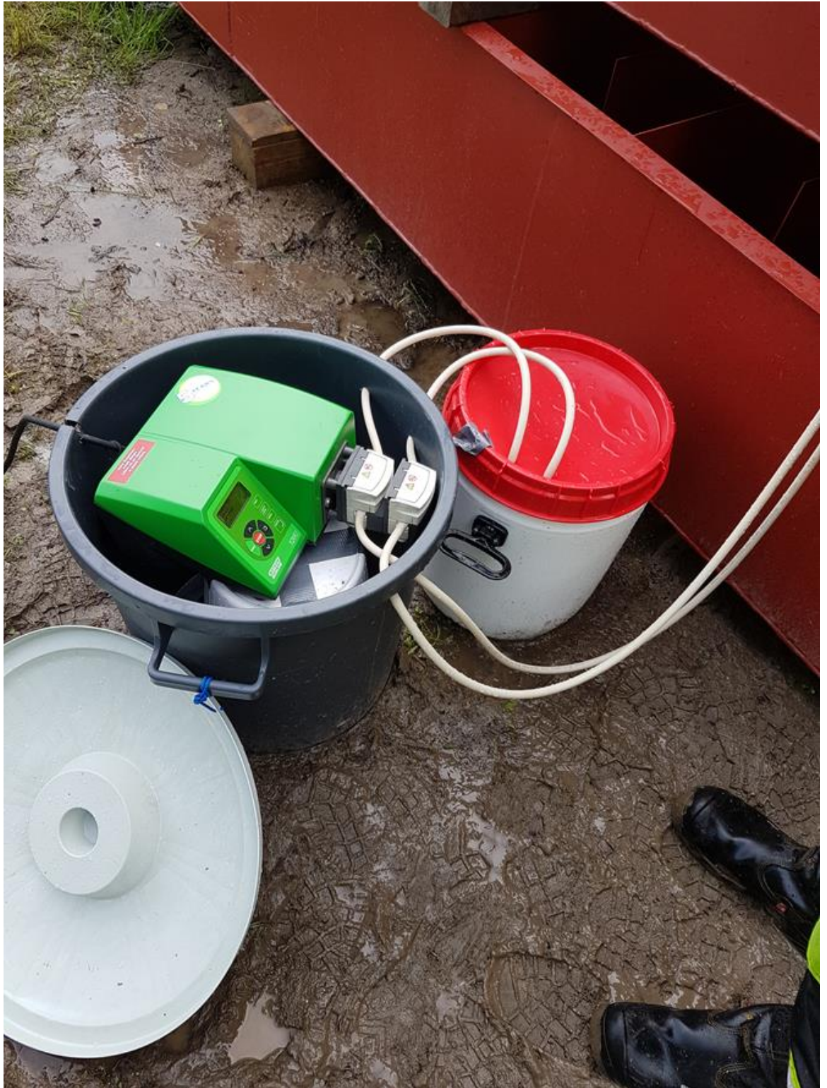
Kuvio 3 Biopolymeeriliuoksen syöttöpumppu eli letkupumppu
