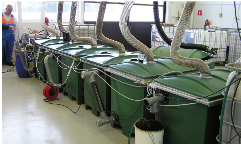
KUVIO 6. Maa- ja elintarviketalouden tutkimiskeskuksen (MTT) Jokioisten tutkimusasemalla oleva liotelannan biologisen käsittelyprosessin prototyyppi (Mustonen 2008)
