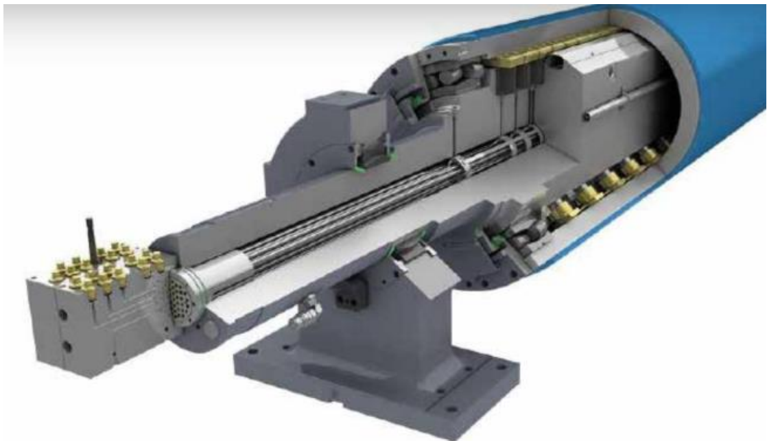
Kuvio 1. Periaatekuva taipumakompensoidusta Sym CD -telasta (Hydrauliikka turvaa... 2015, 31)
