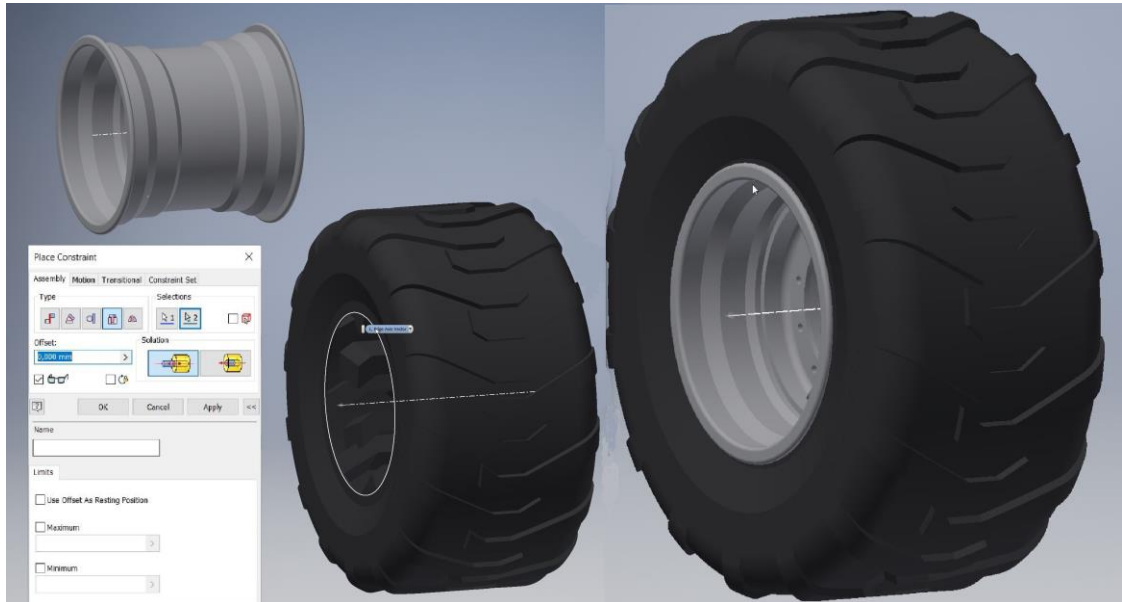
KUVA 13. Renkaan ja vanteen yhdistäminen
