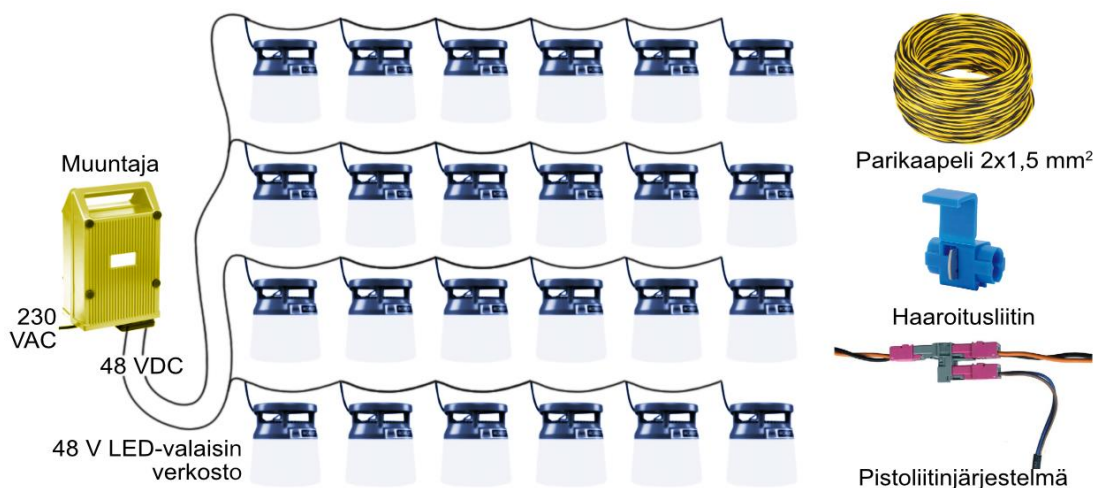
KUVA 4. Kuvassa on esitetty pienenjännite LED-valaistusjärjestelmä ja sen osat.
