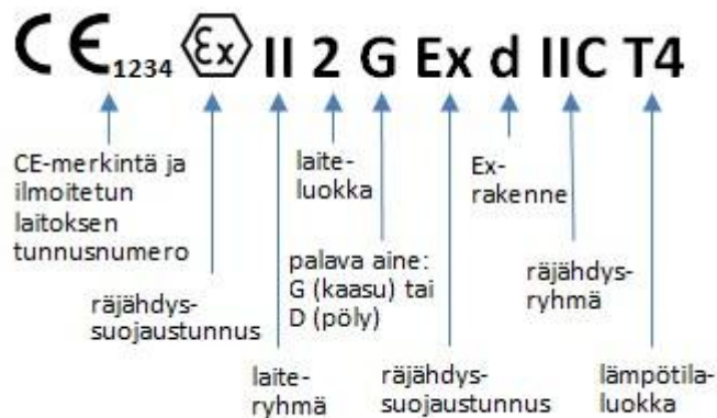
Kuva 2. ATEX-laitteen CE-merkintä ja räjähdysuojauksen erikoismerkintä [7]
