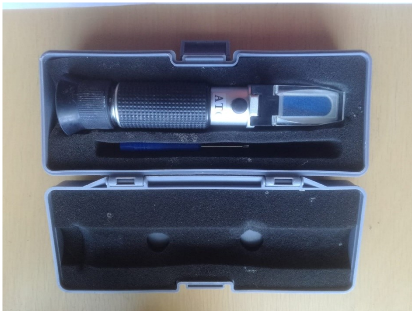
Kuva 5. Refraktometrillä mitattiin maidon brix-arvo (%) (kuva: Piia Kairenius)
