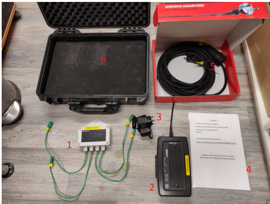
Kuva 4 Etäluettavan loggerin varustus. Laitteistoon kuuluu: mittalaite (1), lähetin (2), lähettimen virtajohto (3), tunnukset ja käyttöohje (4), jatkojohto (5, hankittu erikseen) ja salkku välineille (6)
