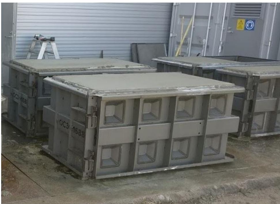
Kuva 8 Koevalussa käytetty muotti täyteen valettuna
