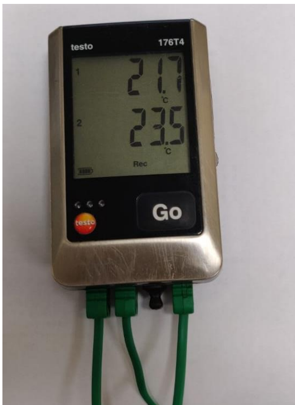
Kuva 3 Kuva tallentavasta loggerista. Näytössä näkyvissä 1 ja 2 kanavien ajantasaiset mittausarvot
