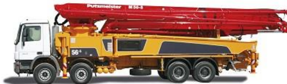
Kuva 8 Autobetonipumppu puomikoneen kanssa
