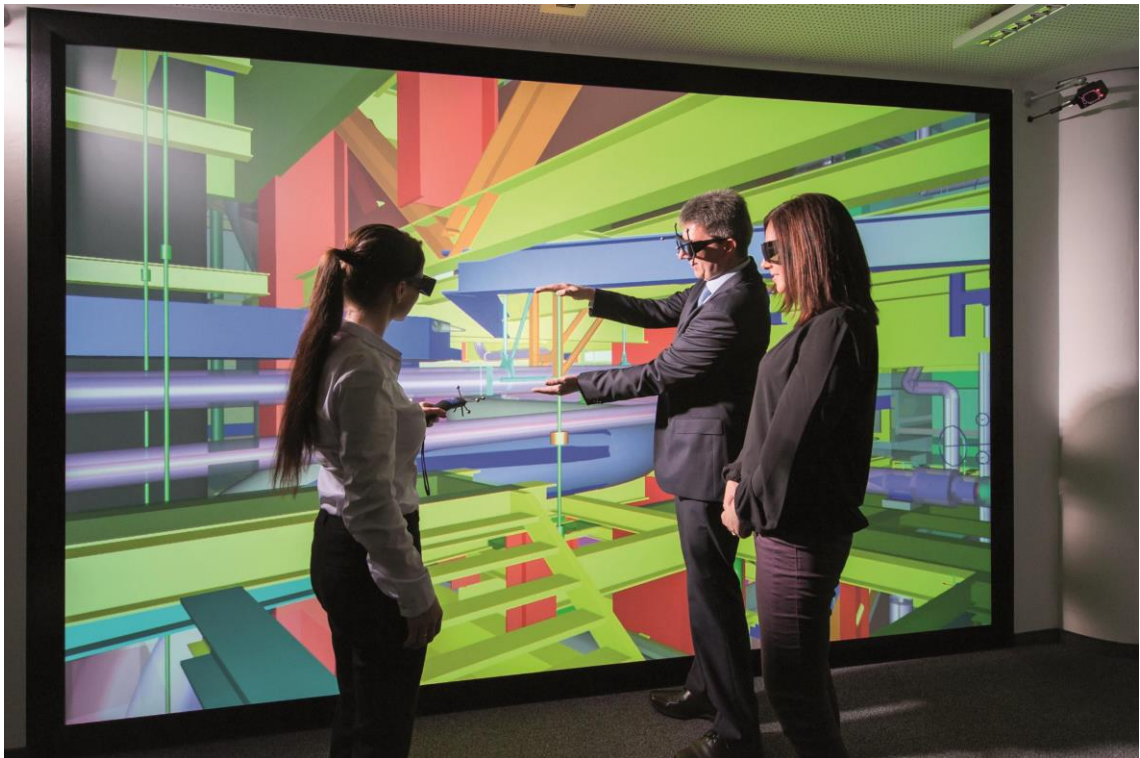
Kuva 23. Suunnittelijoita käyttämässä IC.IDO:n VR-ohjelmistoa, mikä mahdollistaa 1:1 skaalauksen millimetrin tarkkuudella. [48]
