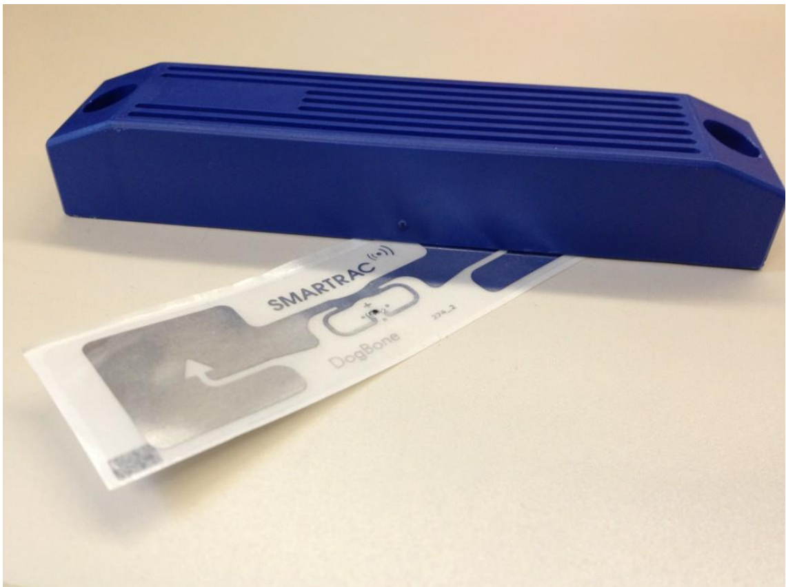
Kuva 27. Aktiivisen RFID-tagin ja passiivisen RFID-tagin kokoverailu. [55]
