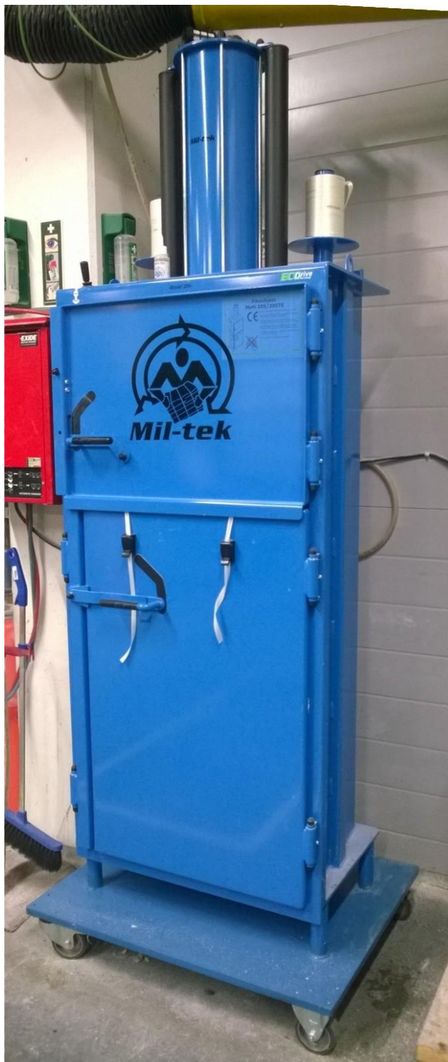
Kuva 9. Mil-tek:in 2205 pahvi- ja muovi paalain, muokattu lisäämällä vahva alusta, jossa on renkaat /11/
