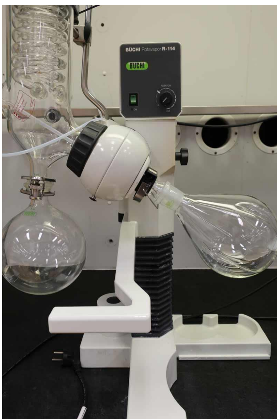
Kuva 12. Testissä ja ioninvaihdossa käytetty pyöröhaihdutin ja kolvi.
