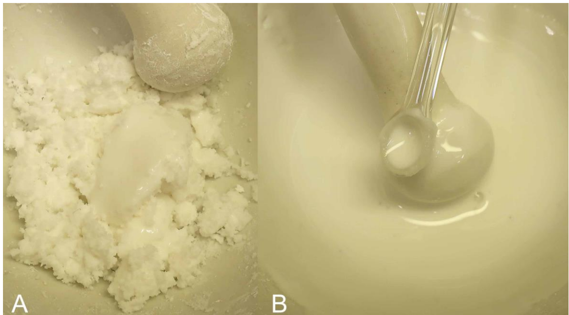
Kuva 7. A: Aletaan lähestyä oikeaa rakennetta, kun seos alkaa kokkaroitua ja kokkareet näyttävät sulavan. B: Rakeiden lusikoiminen voidaan aloittaa, kun seos on tasaista ja juoksevaa.
