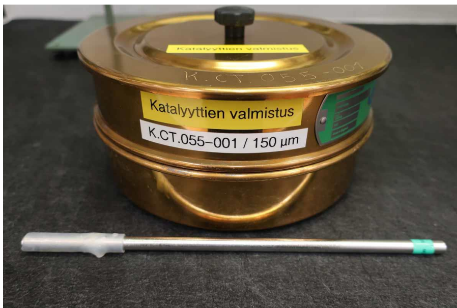
Kuva 10. Hankaukseen seulapakka ja metallinen sauva, jossa kumi pehmuste päässä. Sauvaa käytettiin naputtelussa.
