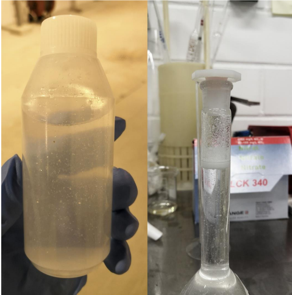
Kuva 10. Vasemmalla Stannine liuotettuna tislattuun veteen ja oikealla 10-prosenttiseen suolahappoon. Molempien kanssa Stannine muodostaa valkoisia hiutaleita [Karlstrom 2018.]
