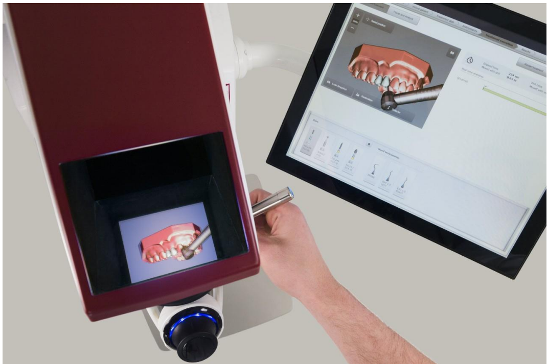
KUVA 1. Simodont Dental Trainer, näyttöruutujen näkymä käyttäjälle. (Moog)
