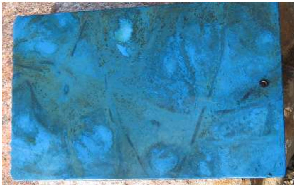
Kuva 10. Epoksin maalipinta meri upotuksen jälkeen
