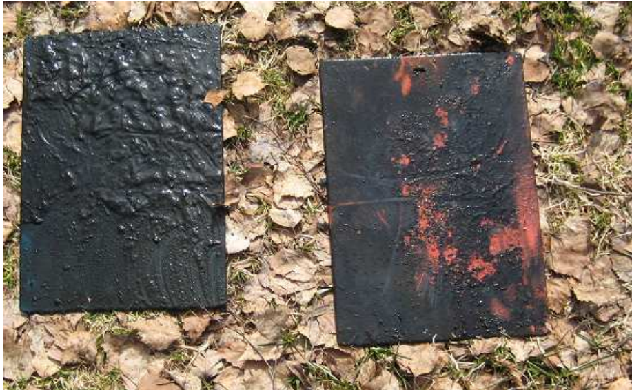
Kuva 9. Koelevyt juuri nostettuna merestä. Vasemmalla epoksinnoite ja oikealla AF-pinnoite
