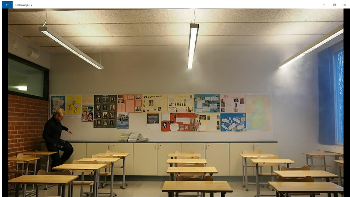
Kuva 4. Merkkisavun leviäminen tilassa 100 %:n ilmavirralla 60 sekunnin kohdalla.
