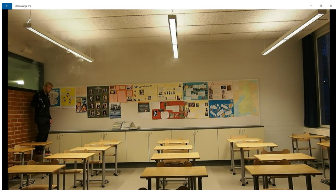
Kuva 5. Merkkisavun leviäminen tilassa 30 %:n ilmavirralla 60 sekunnin kohdalla.
