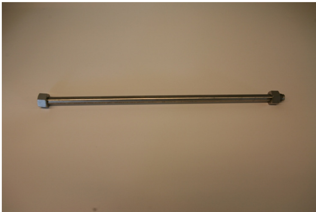
Kuva 5. Rakennetun laitteiston reaktoriputki helmiliittimineen
